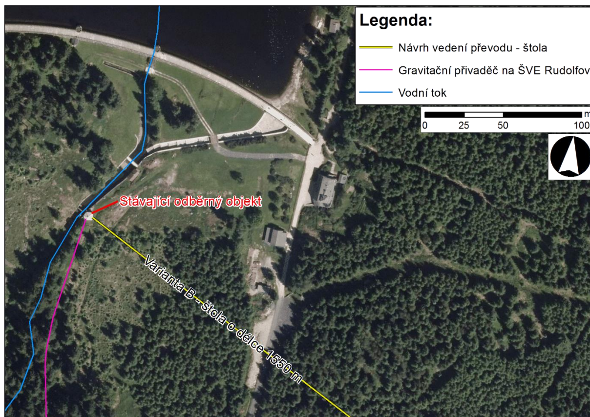
obr. 50 - Schéma napojení na odběrný objekt, varianta B
