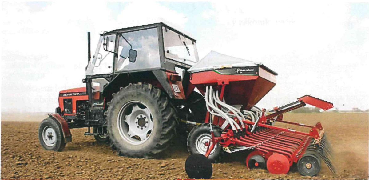
Jenoduché nastavení výsevku pomocí nastavení pracovní šířky dávkovacího válce
