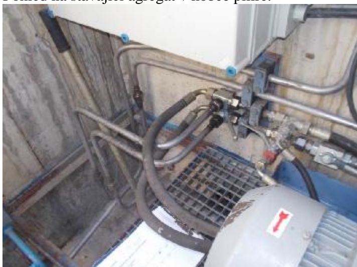
Hydraulické vedení k přilehlému hydromotoru
