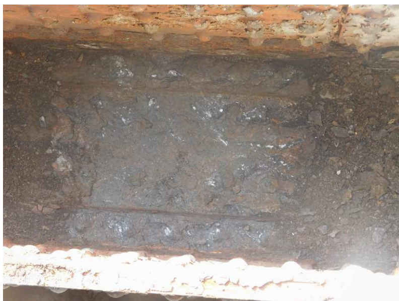
Obr. 2.37 – detail sondy 8, spodní pás pouze s povrchovým korozním oslabením
