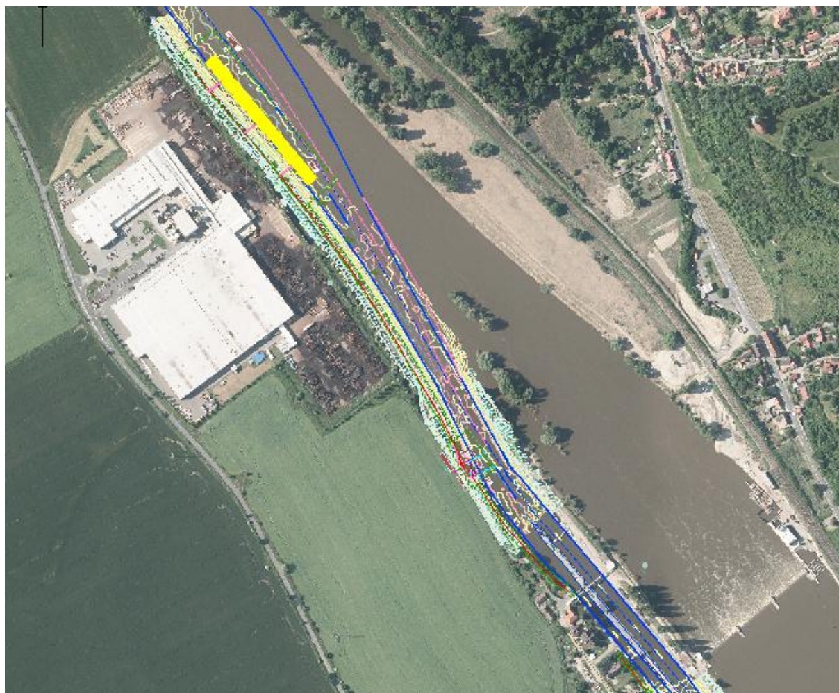
Obr. 2.1 Dolní čekací stání pro návrhové plavidlo 200x12 m (žlutě).
