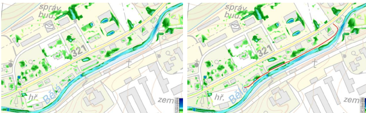
Obr. 105 Rozlivy po opadnutí povodně, v důsledku přirozeného odvodnění (s výjimkou bezodtokových míst dle DMT), vpravo varianta s terénní úpravou SO 10 a SO 04, vlevo varianta bez realizace TÚ a bez SO 04. Rozdíly prakticky shodné s variantou bez TÚ (viz Obr. 69, Obr. 70)
