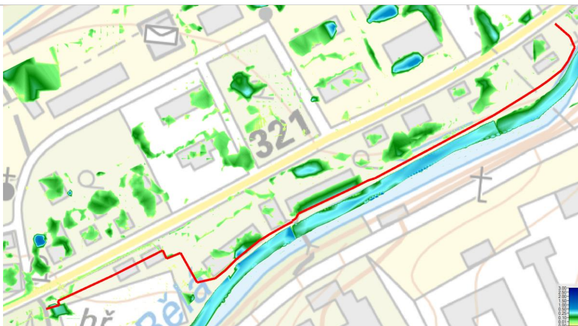
Obr. 70 Mapa hloubek/zaplavení po „opadnutí povodně průtoku 78,8 \text{ m}^3/\text{s} ( =Q_{N=100} )“ situace v čase t = 13 hod. dle návrhového hydrogramu ( Q_a=1,16 \text{ m}^3/\text{s} ) – 5 hodin po kulminaci Q_{100} (hydrogram viz Obr. 13). Varianta s SO 04
