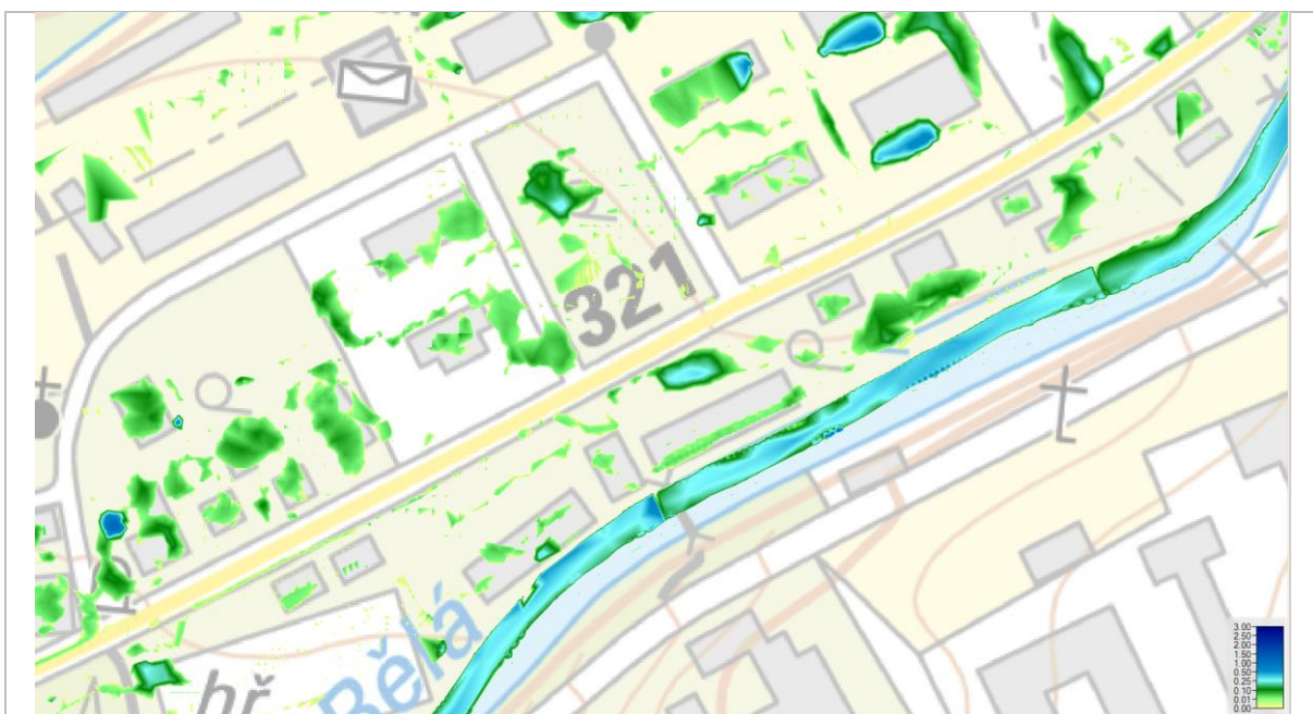
Obr. 69 Mapa hloubek/zaplavení po „opadnutí povodně průtoku 78,8 \text{ m}^3/\text{s} ( =Q_{N=100} )“ situace v čase t = 13 hod. dle návrhového hydrogramu ( Q_a=1,16 \text{ m}^3/\text{s} ) – 5 hodin po kulminaci Q_{100} (hydrogram viz Obr. 13). Varianta bez SO 04
