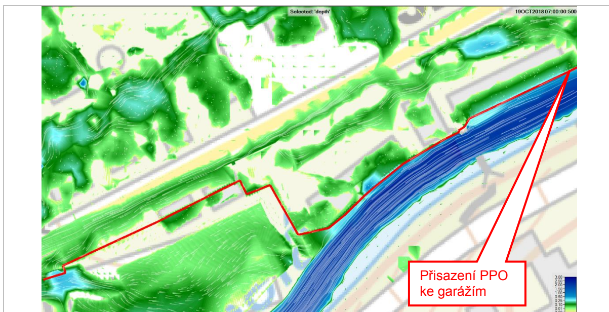
Obr. 78 Simulace srážky T=6 hod., i=61,2 l/s. ha při průchodu Q=50 m 3 /s ( \approx Q_{20} ). Konec srážky (čas simulace t=7 hod.), situace podél spodní části SO 04-2 (plocha A_{celk.} , viz Obr. 73).
