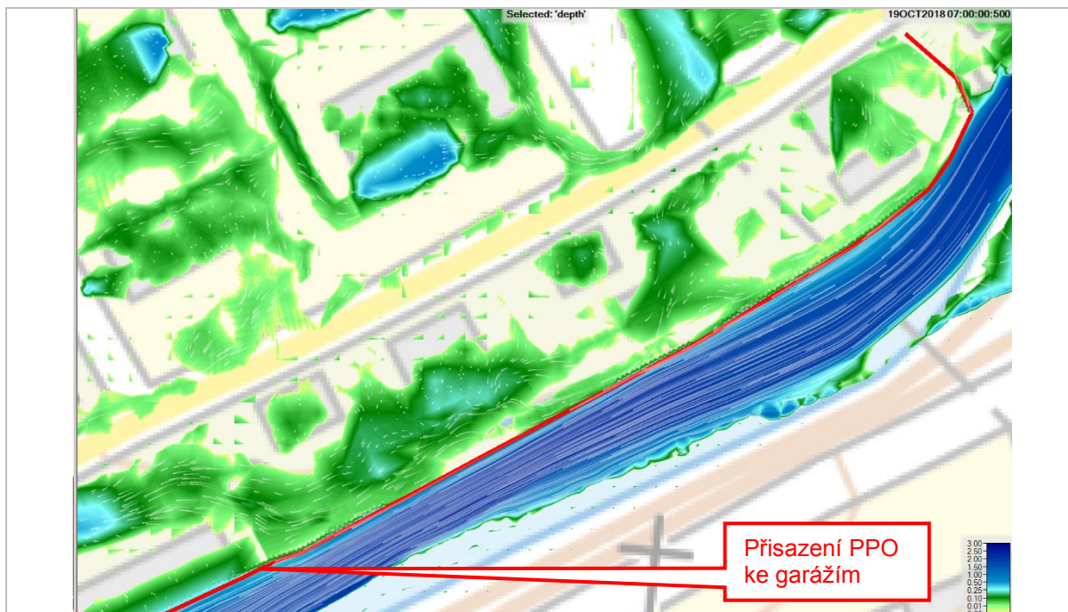
Obr. 77 Simulace srážky T=6 hod., i=61,2 l/s. ha při průchodu Q=50 m 3 /s ( \approx Q_{20} ). Konec srážky (čas simulace t=7 hod.), situace podél vrchní části SO 04-1 (plocha A_1 , viz Obr. 73).
