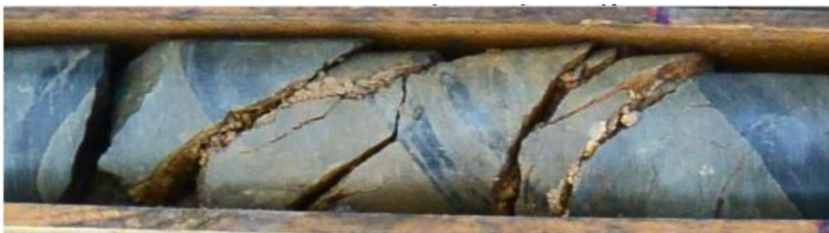
Obr. 4. Zelenohnědé zabarvení navětralých drob, jílovitá výplň trhlin
