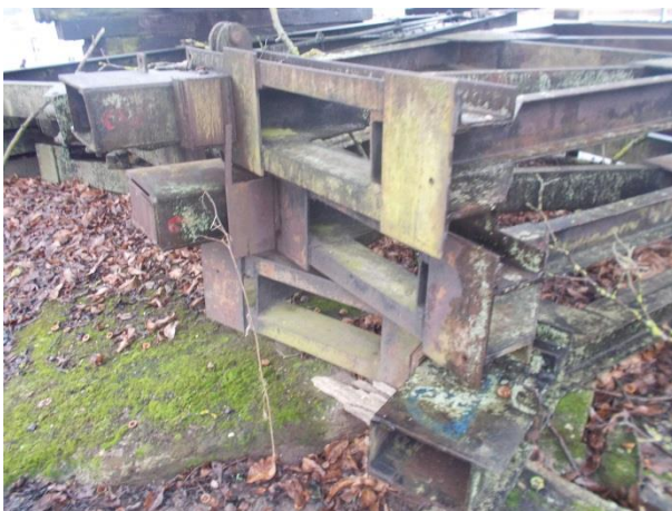
Stávající slupice dolního provizorního hrazení
