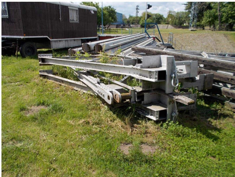
Slupice horního provizorního hrazení na VD Hradištko
