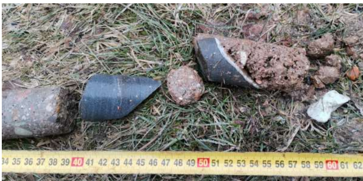
Detail vzorku – betonové jádro s kameny
