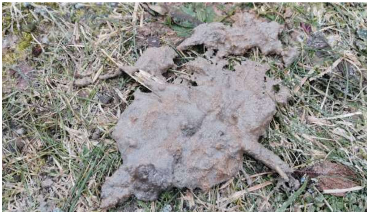
Vodou rozplavené betonové jádro z vrtu
