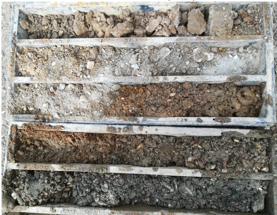
208.56 m n. m. Foto 34 - Profil vrtu SV-22 - úsek 0 - 5 m, počátek profilu vlevo nahoře
