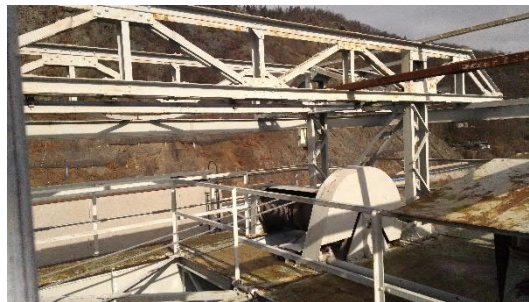
Lanový naviják hlavního zdvihacího zařízení
