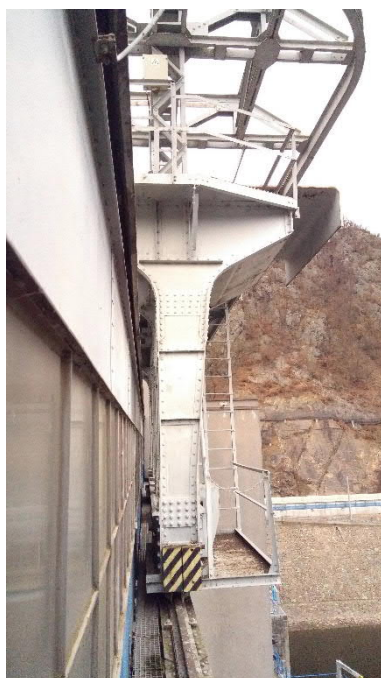
Podvozek jeřábu na povodní straně
