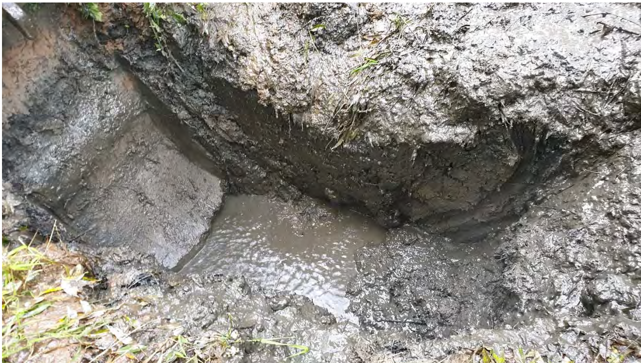
Obr. 01: Dokumentační foto sondy S1, výkop po konečnou hloubku sondy, zeminy kašovité, zřejmé přítoky vody do výkopu
