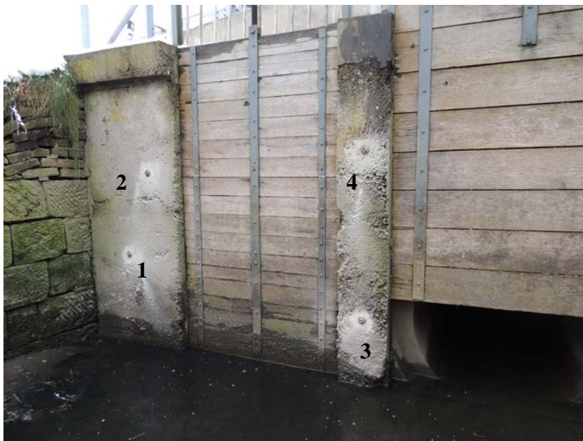
Pohled na místa zkoušek soudržnosti betonu na stěně se stavidly
