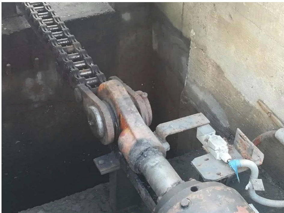
Pohled na sčepování řetězu s hydromotorem
