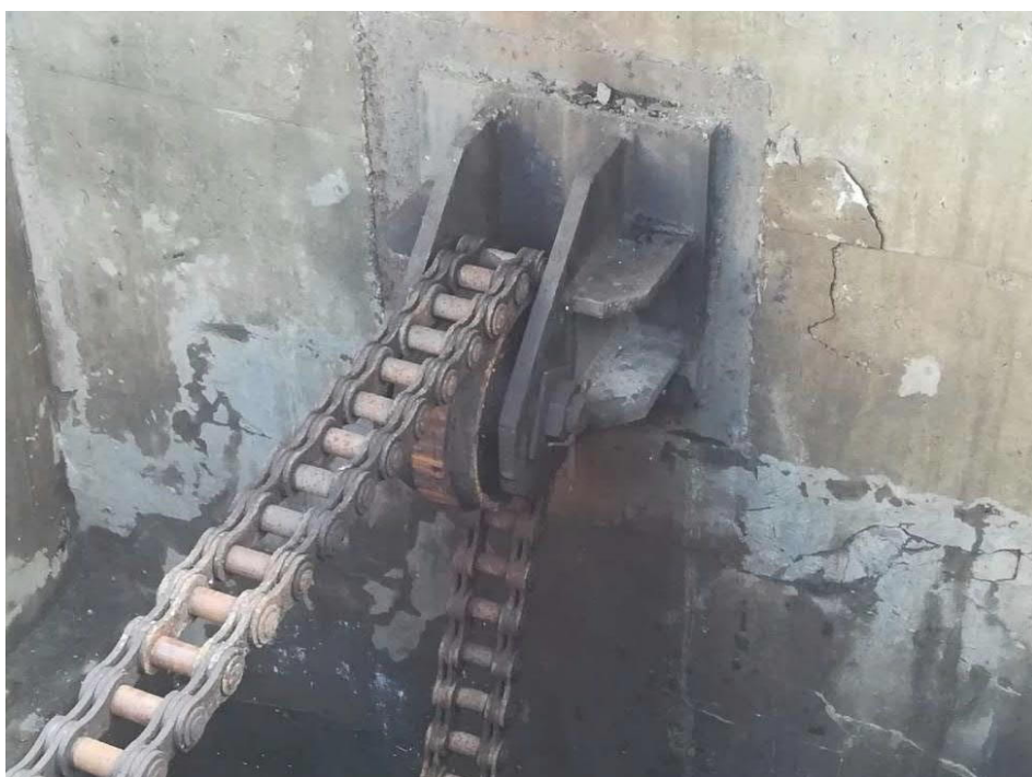
Detail konzoly s řetězovou kladkou
