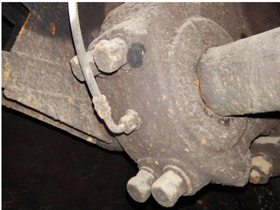
Detail ložiska a přívodem maziva
