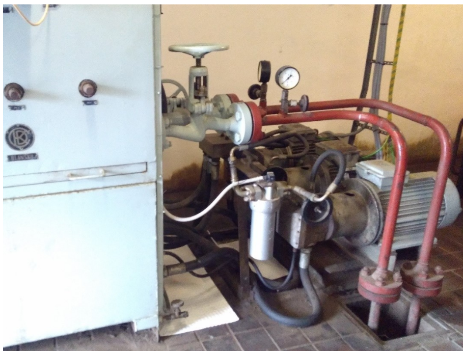
Pohled na stávající hydraulický agregát – čelní strana
