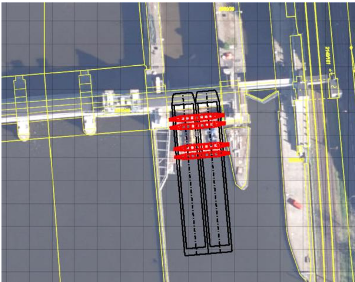
Schéma umístění plavidla s hradidly při montáži na vodní dílo
