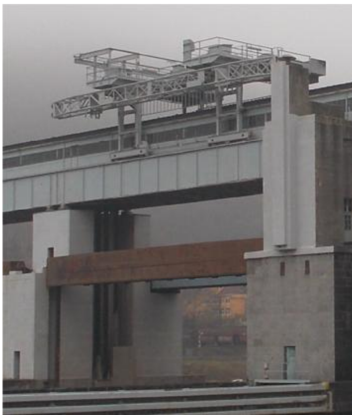
Manipulační portálový jeřáb horních hradidel PH – 54 t
