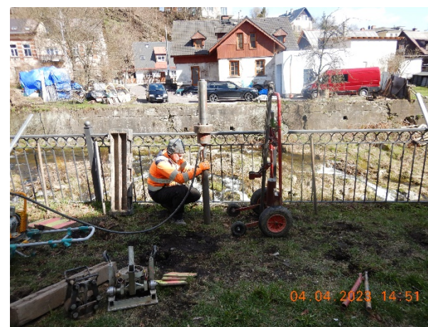
Obr. 5,6: Pohled k sv. na hloubení sondy (S2)A soupravou Argos-HH; Pohled k vj. na místo hloubení sondy (S2)E.
