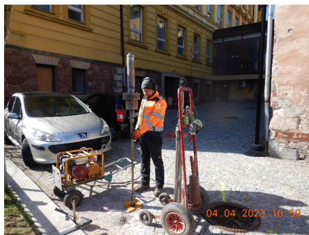
Obr. 1,2: Pohled k sv. na hloubení sondy S1 soupravou Argos-HH; Pohled k jz. na provádění zkoušky DPH1.
