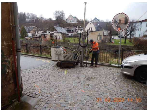
Obr. 1,2: Pohled k sv. na hloubení sondy S1 soupravou Argos-HH; Pohled k jz. na provádění zkoušky DPH1.
