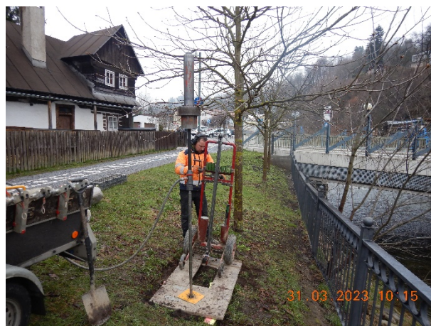
Obr. 7,8: Pohled k jz. na hloubení sondy S3 soupravou Argos-HH; Pohled k sv. na provádění zkoušky DPH3.
