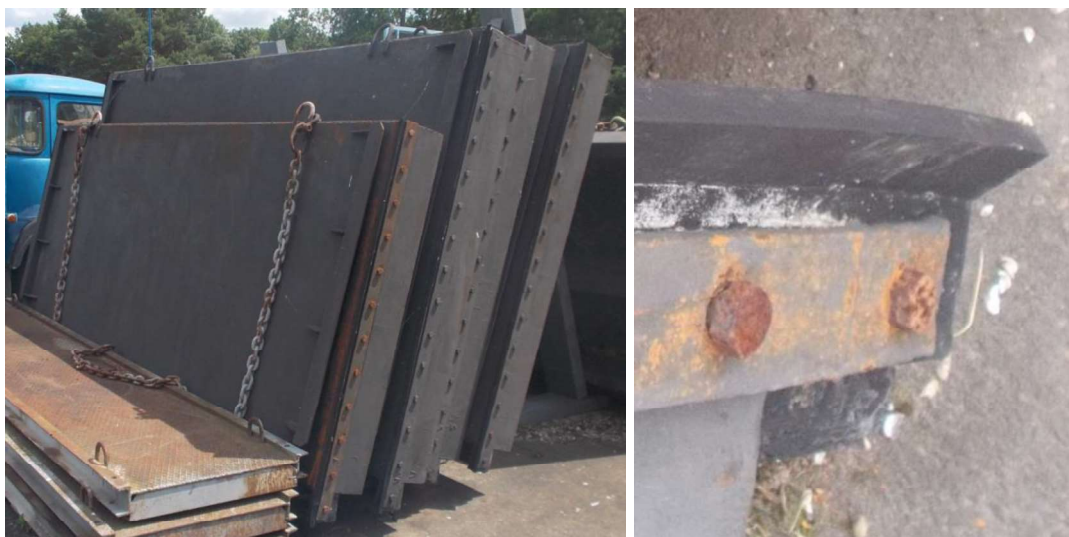
Desky provizorního hrazení – velké a malé, boční těsnění
