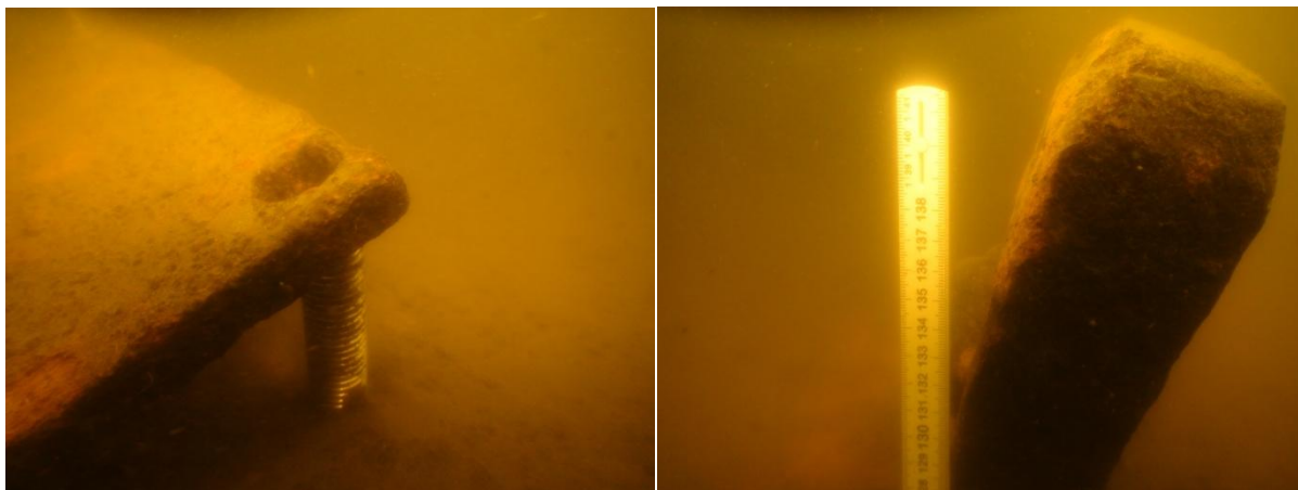
Foto-Havarijní stav ok pro montáž slupic
