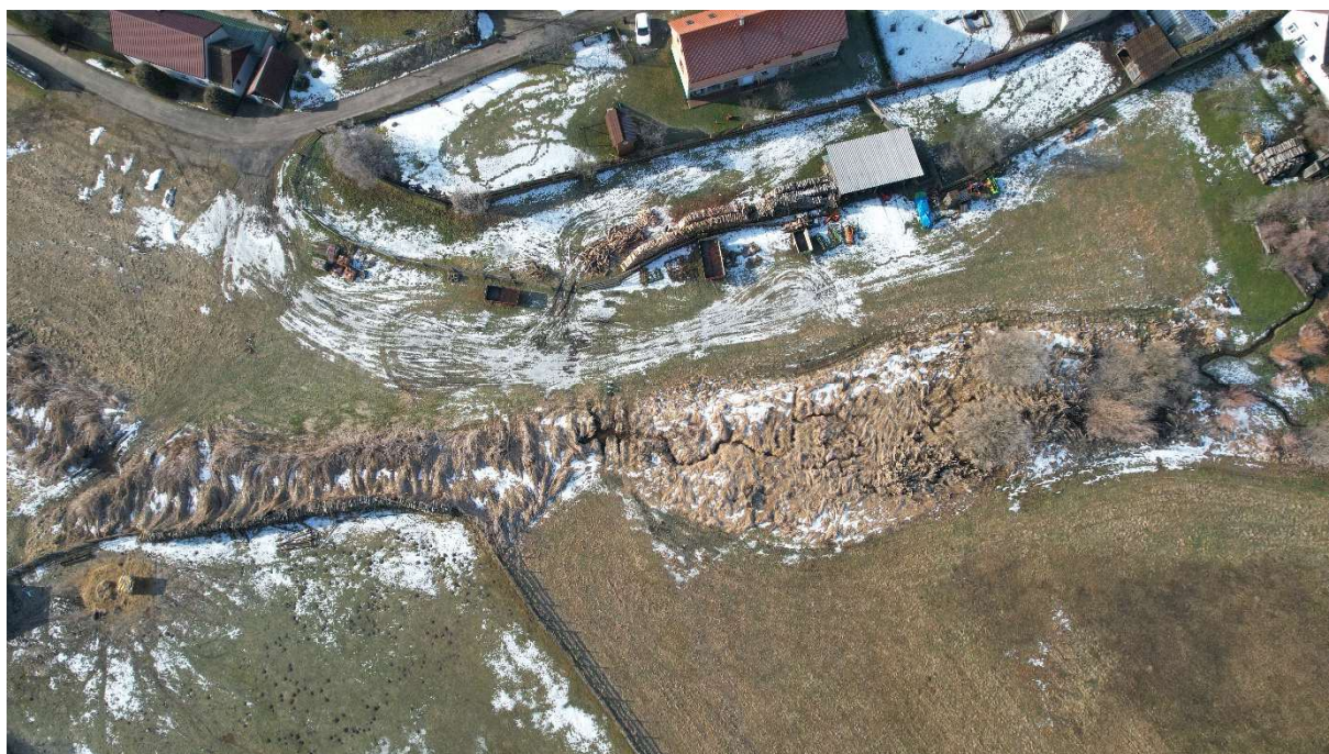
Obr. č.4 – Pohled na Řečický zatrubněný potok – nefunkční zatrubnění (únor 2024)
