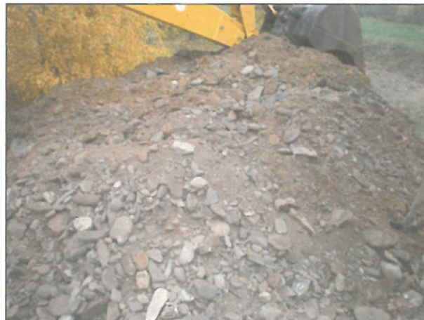
Vnitřní prostor sondy a štěrkopískový materiál ze sondy, při dně hnědé písky
