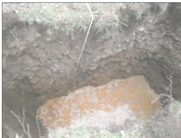
Měření poklesu hladiny v sondě při vsakovací zkoušce a studna se záměrem HPV
