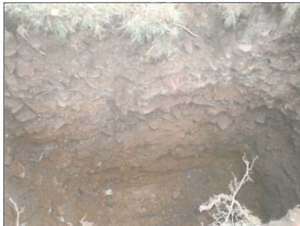
Vnitřní prostor sondy a štěrkopískový materiál ze sondy, při dně hnědé písky
