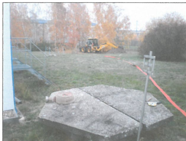
Měření poklesu hladiny v sondě při vsakovací zkoušce a studna se záměrem HPV
