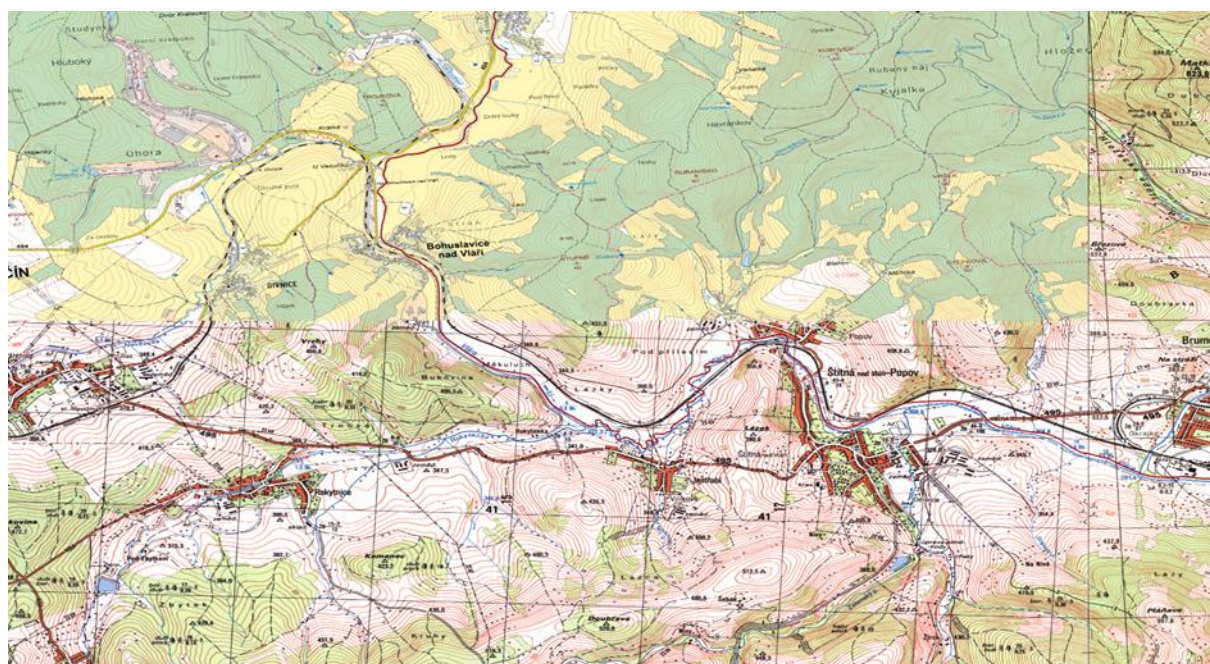
Obrázok 5: Detail napojenia ZTM ČR ZM SR v mierke 1:25 000. Zjavný je rozdiel v použití znakového kľúča a nenadväzujúce líniové prvky.
