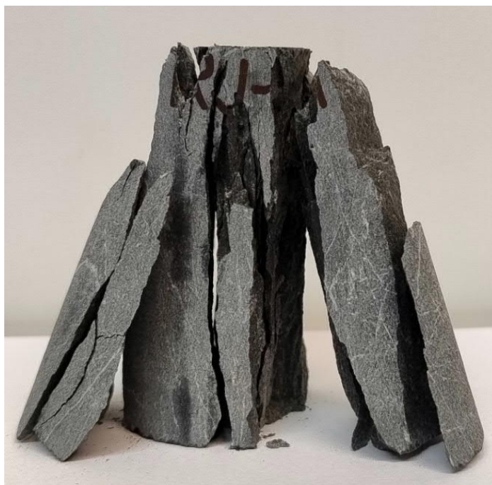
Obr. 9 a 10 Zkušební těleso prachové břidlice z vrtu RJ-1 před a po provedení zkoušky (VUT, 2025)
