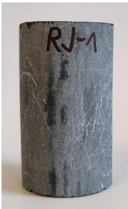
Obr. 9 a 10 Zkušební těleso prachové břidlice z vrtu RJ-1 před a po provedení zkoušky (VUT, 2025)
