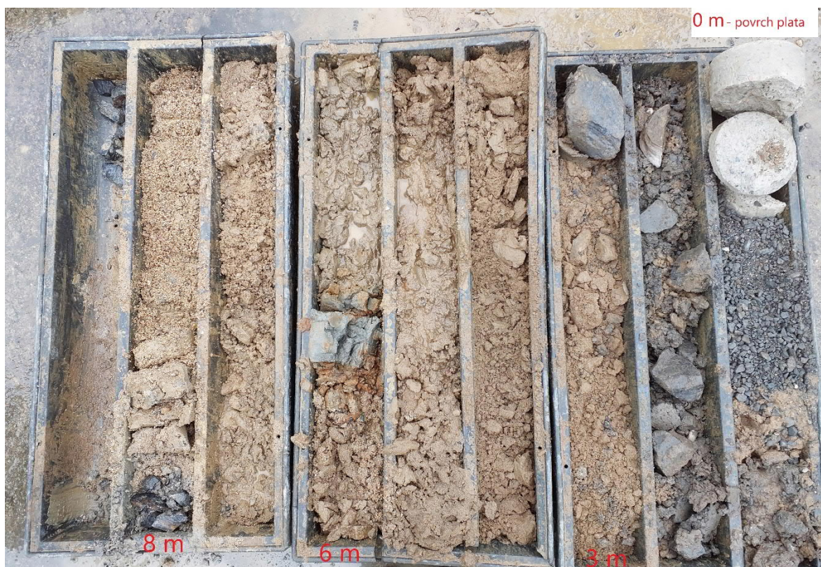
Foto 2 Litologický profil sondy RJ-1
