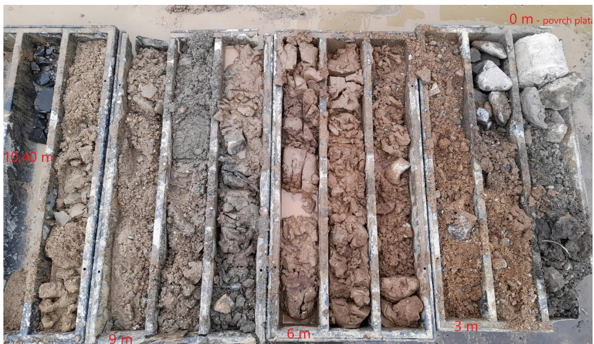
Foto 4 Litologický profil sondy RJ-2
