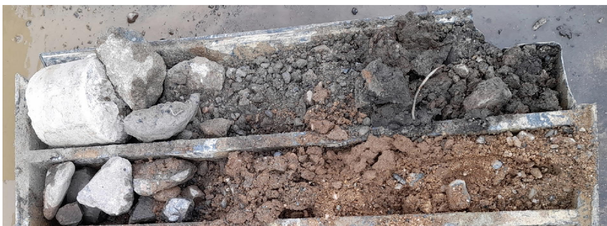
Obr. 5 Vrtné jádro ze sondy RJ-2 – betonové plato, kamenný podsyp a navážka (Musel, 2025)
