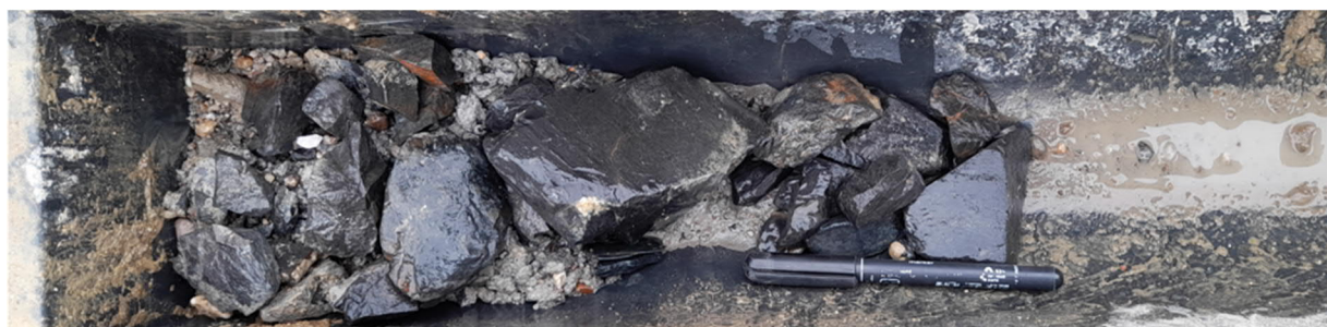
Obr. 8 Vytěžená prachová břidlice geotech. tř. R2 z vrtu RJ-2; 10,0 – 10,4 m (Musel, 2025)
