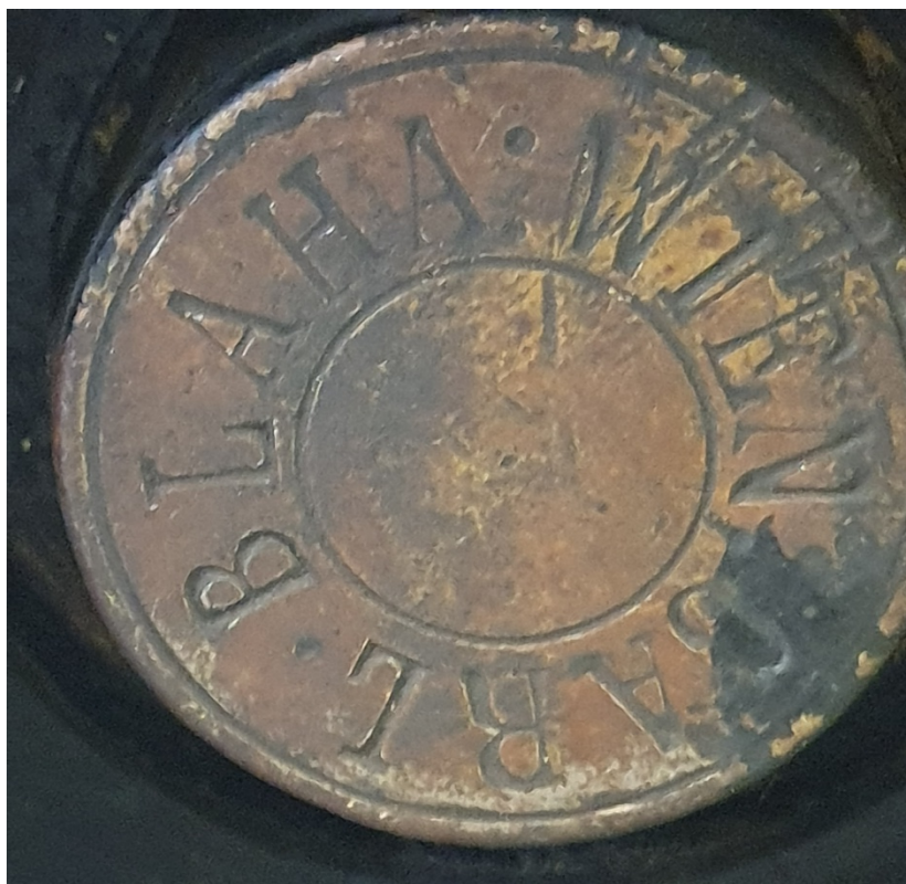
Obrázek 11- Detail signování matic náprav
