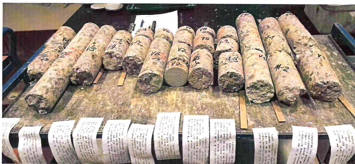
Obr. 1: Pohled na jádrové vývrty V1 až V12. Vývrty byly odebrány z klenbové nosné konstrukce 3. mostního pole.
