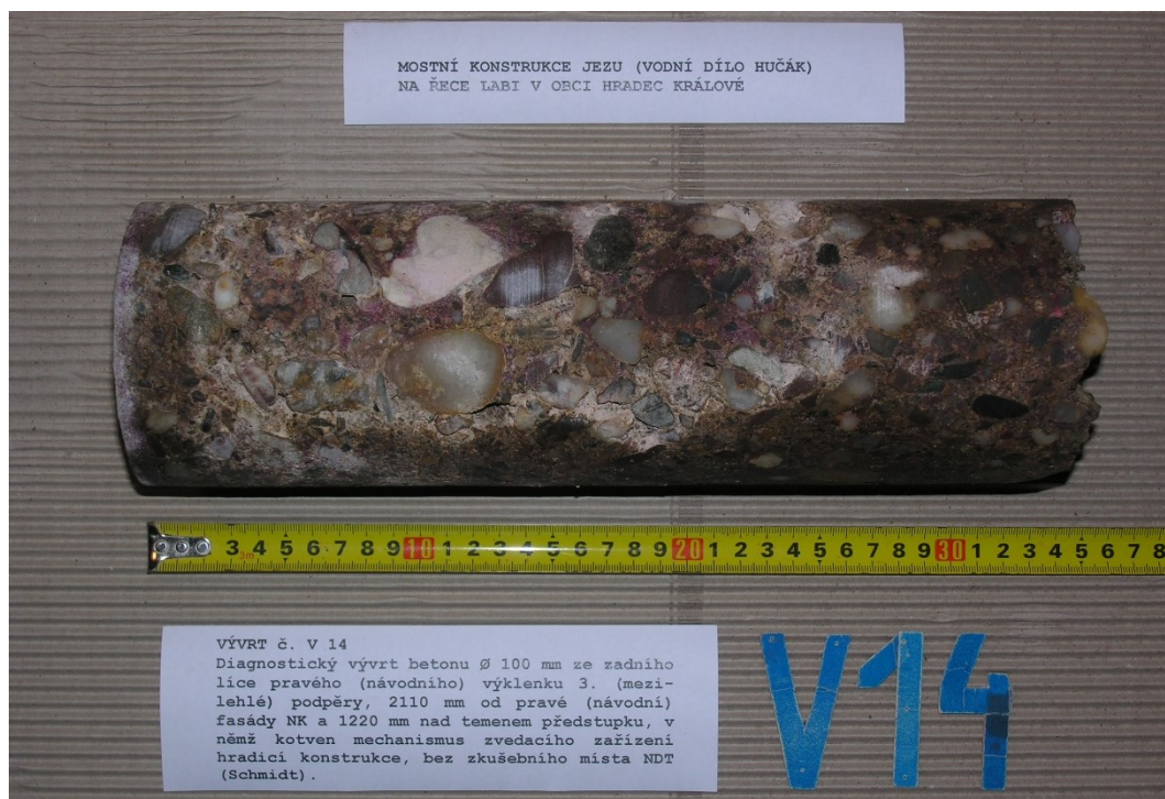
Obr. G86-114 VÝVRT č. V14. Diagnostický vývrt betonu Ø 100 mm ze zadního lince pravého (návodního) výklenku 3. (mezilehlé) podpěry, 2110 mm od pravé (návodní) fasády NK a 1220 mm nad temenem předstupku, v němž kotven mechanismus ovládacího zařízení hradicí konstrukce, bez zkušebního místa NDT (Schmidt).
