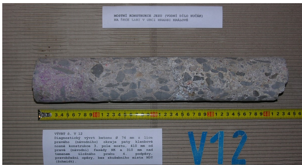
Obr. G86-112 VÝVRT č. V12. Diagnostický vývrt betonu Ø 74 mm z líce pravého (návodního) okraje paty klenbové nosné konstrukce 3. pole mostu, 410 mm od pravé (návodní) fasády NK a 310 mm nad temenem úložného prahu 4. podpěry, pravobřežní opěry, bez zkušebního místa NDT (Schmidt).
