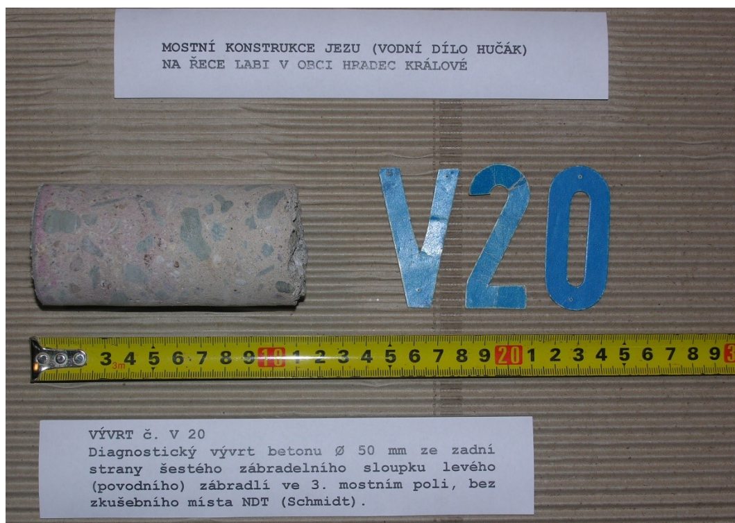
Obr. G86-120 VÝVRT č. V20. Diagnostický vývrt betonu Ø 50 mm ze zadní strany šestého zábradelního sloupku levého (povodního) zábradlí ve 3. mostním poli, bez zkušebního místa NDT (Schmidt).
