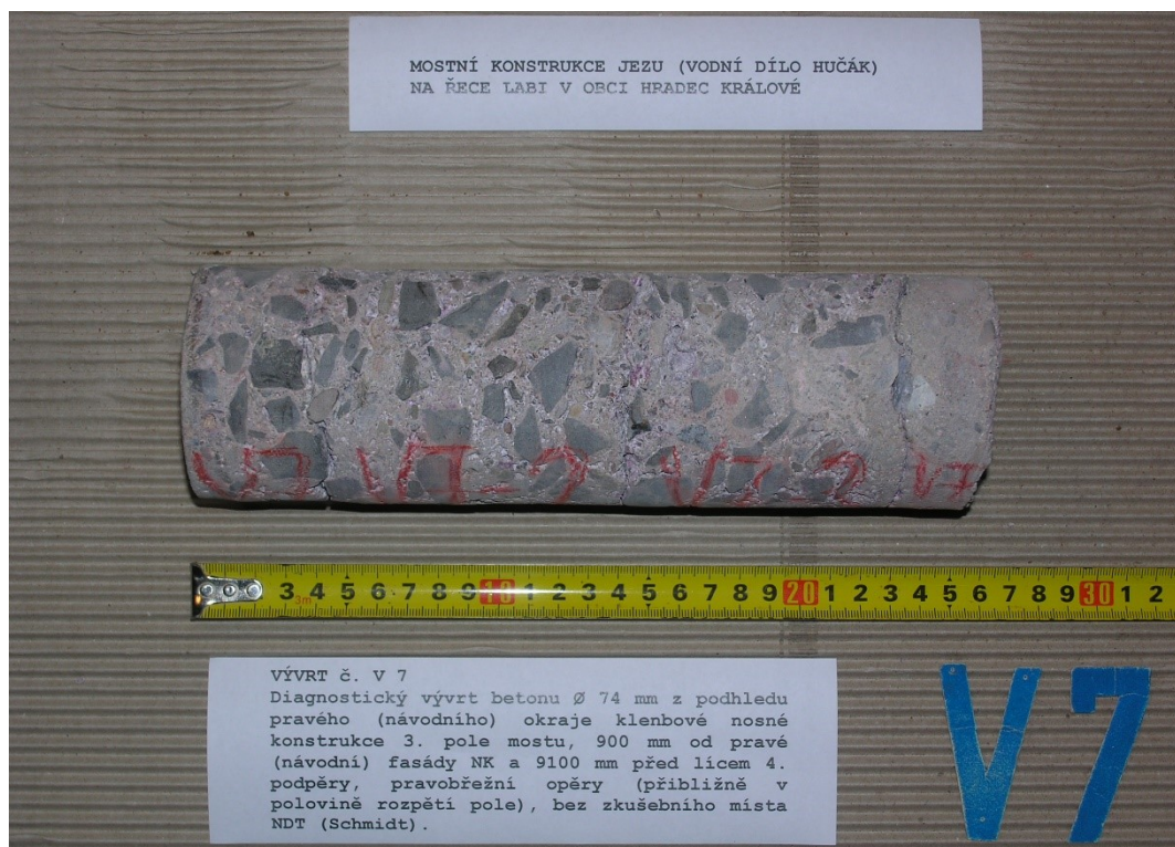
Obr. G86-107 VÝVRT č. V7. Diagnostický vývrt betonu Ø 74 mm z podhledu pravého (návodního) okraje klenbové nosné konstrukce 3. pole mostu, 900 mm od pravé (návodní) fasády NK a 9100 mm před lícem 4. podpěry, pravobřežní opěry (přibližně v polovině rozpětí pole), bez zkušebního místa NDT (Schmidt).
