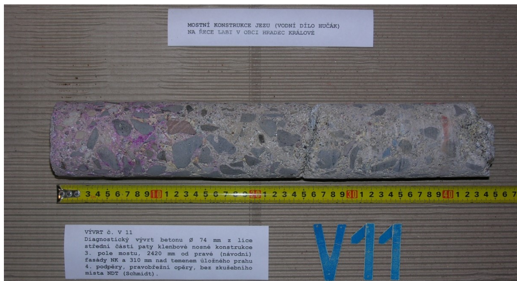
Obr. G86-111 VÝVRT č. V11. Diagnostický vývrt betonu Ø 74 mm z líce střední části paty klenbové nosné konstrukce 3. pole mostu, 2420 mm od pravé (návodní) fasády NK a 310 mm nad temenem úložného prahu 4. podpěry, pravobřežní opěry, bez zkušebního místa NDT (Schmidt).
