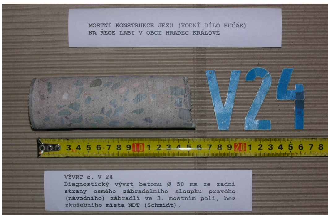
Obr. G86-124 VÝVRT č. V24. Diagnostický vývrt betonu Ø 50 mm ze zadní strany osmého zábradelního sloupku pravého (návodního) zábradlí ve 3. mostním poli, bez zkušebního místa NDT (Schmidt).
