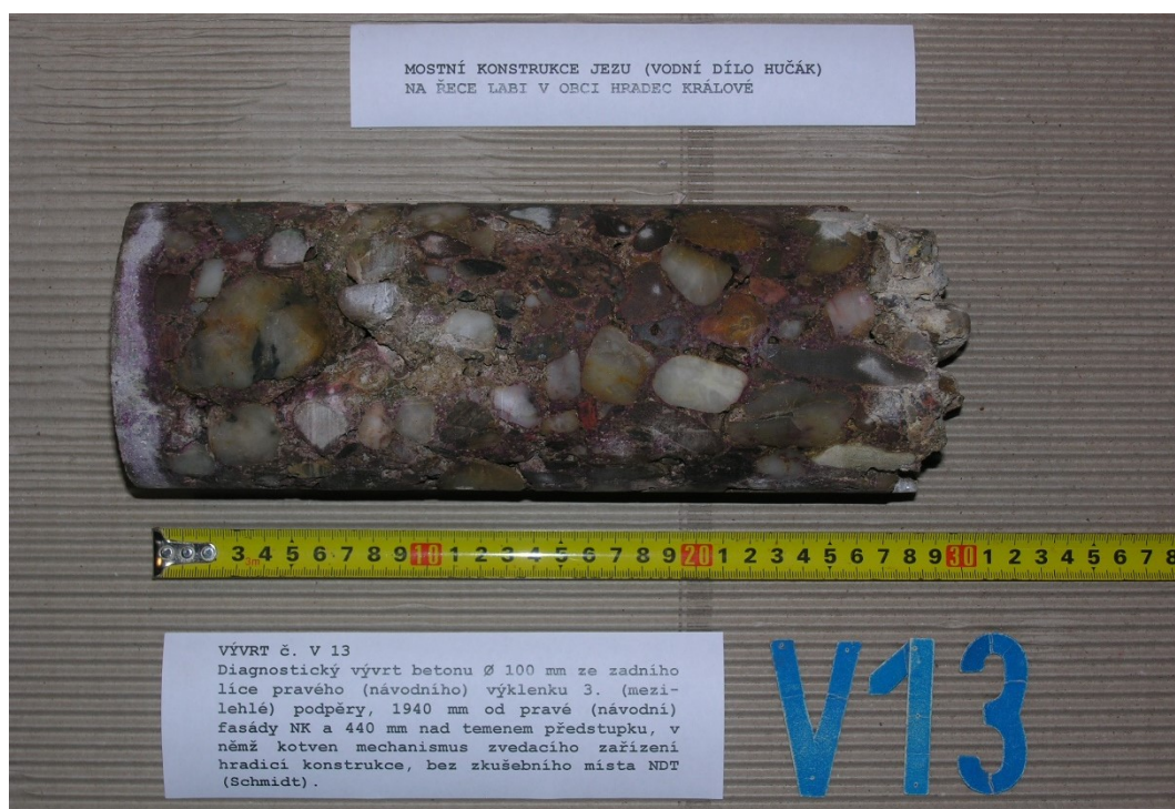
Obr. G86-113 VÝVRT č. V13. Diagnostický vývrt betonu Ø 100 mm ze zadního lince pravého (návodního) výklenku 3. (mezilehlé) podpěry, 1940 mm od pravé (návodní) fasády NK a 440 mm nad temenem předstupku, v němž kotven mechanismus ovládacího zařízení hradicí konstrukce, bez zkušebního místa NDT (Schmidt).
