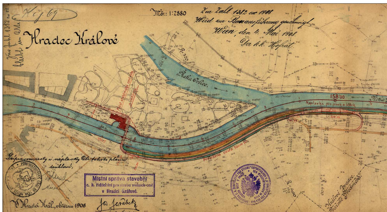
14. Plán upraveného Labe se zakresleným novým jezem a hydroelektrárnou; Expositura c. k. ředitelství pro stavbu vodních cest, 1908, Praha, měřítko 1:2880, Povodí Labe Hradec Králové, spisovna.
