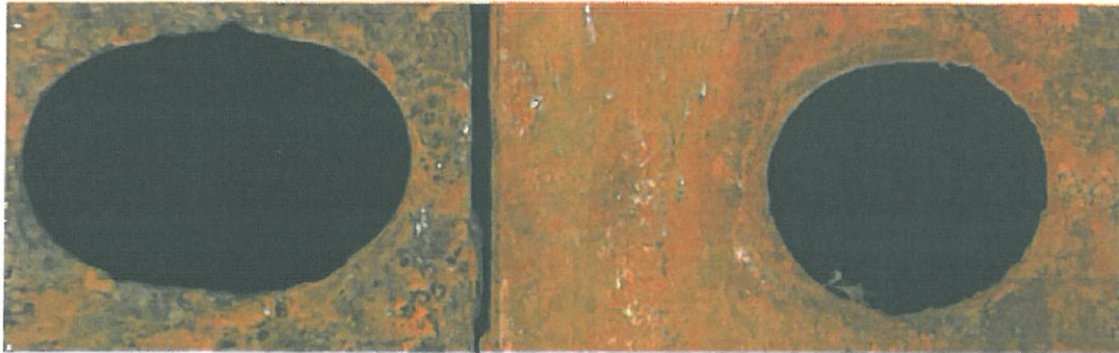
foto č.1-detail vrtání česlí namáhaných ponorem
