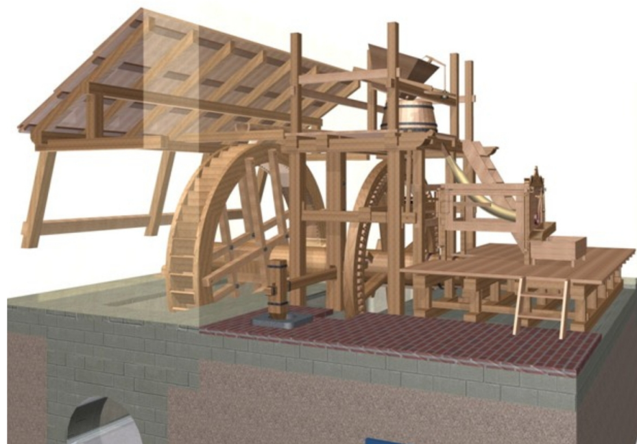
model mlýna - ukázka soukolí elektricky ovládaný pohyb kola model bez vody
