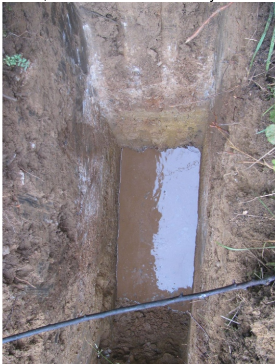
Foto 5 : vsakovací zkouška v sondě K1
