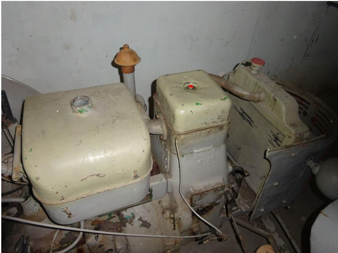
Obr. 3 Pravá strana motoru. V pozadí nep vodní klobouk vzduchového filtru. Dob e je vid t záplata p i-roubovaná na zadní stran bloku.
