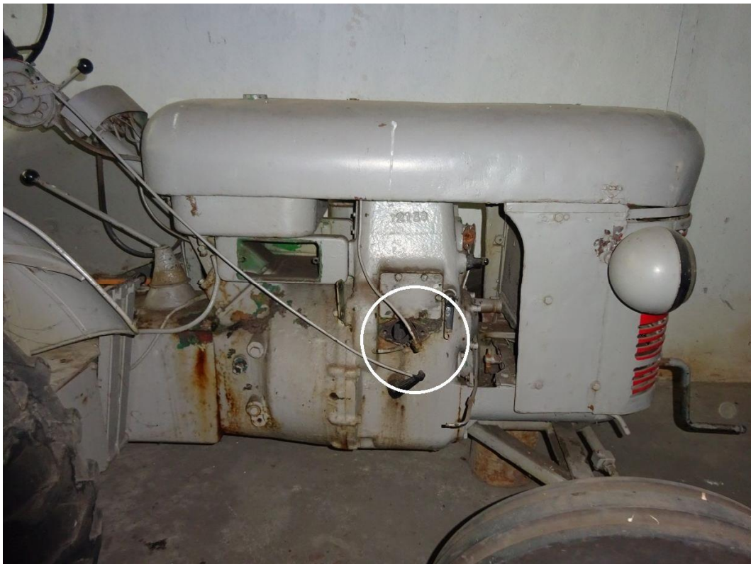
Obr. 4 Chyb ící vst íkovací erpadlo na pravé stran bloku motoru.
