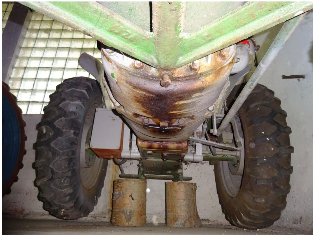
Obr. 6 Spodek traktoru je znečištěn mazadly. Stejně jako na ostatních dílech prosvítají zbytky nánosů starých nátěrů.
