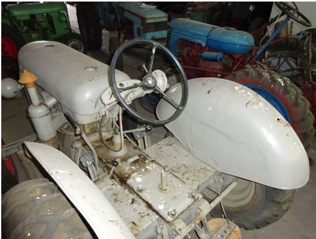
Obr. 7 Stanoviště řidiče. Zcela chybí sedadlo, vlevo za řízení (oko), zářivková provedovka s emisnicí a koncové světlo na pravém blatníku.
