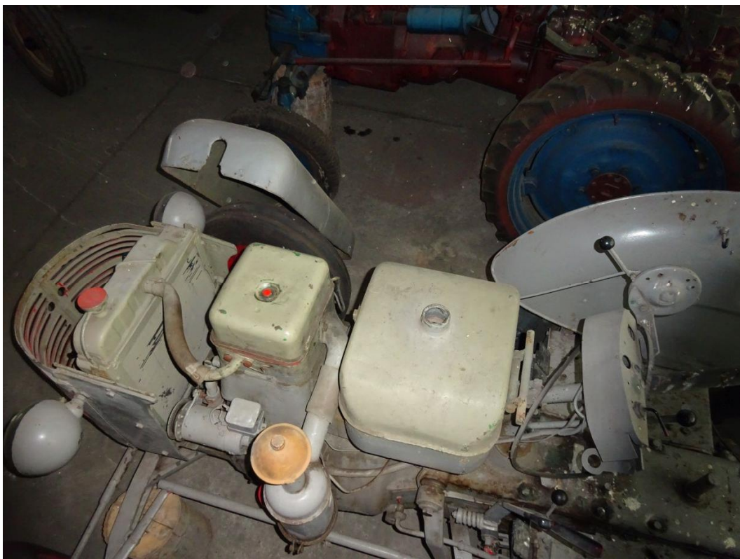
Obr. 5 Motor shora. Dobře je vidět excentrické (nesprávné) umístění plnicího hrdla chladiče.
