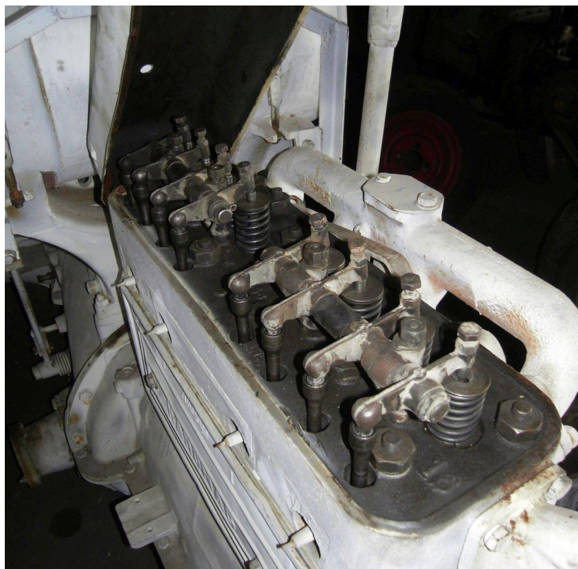
Obr. 4 Traktor Hanomag i zdvihátka ventilů na hlavě motoru.
