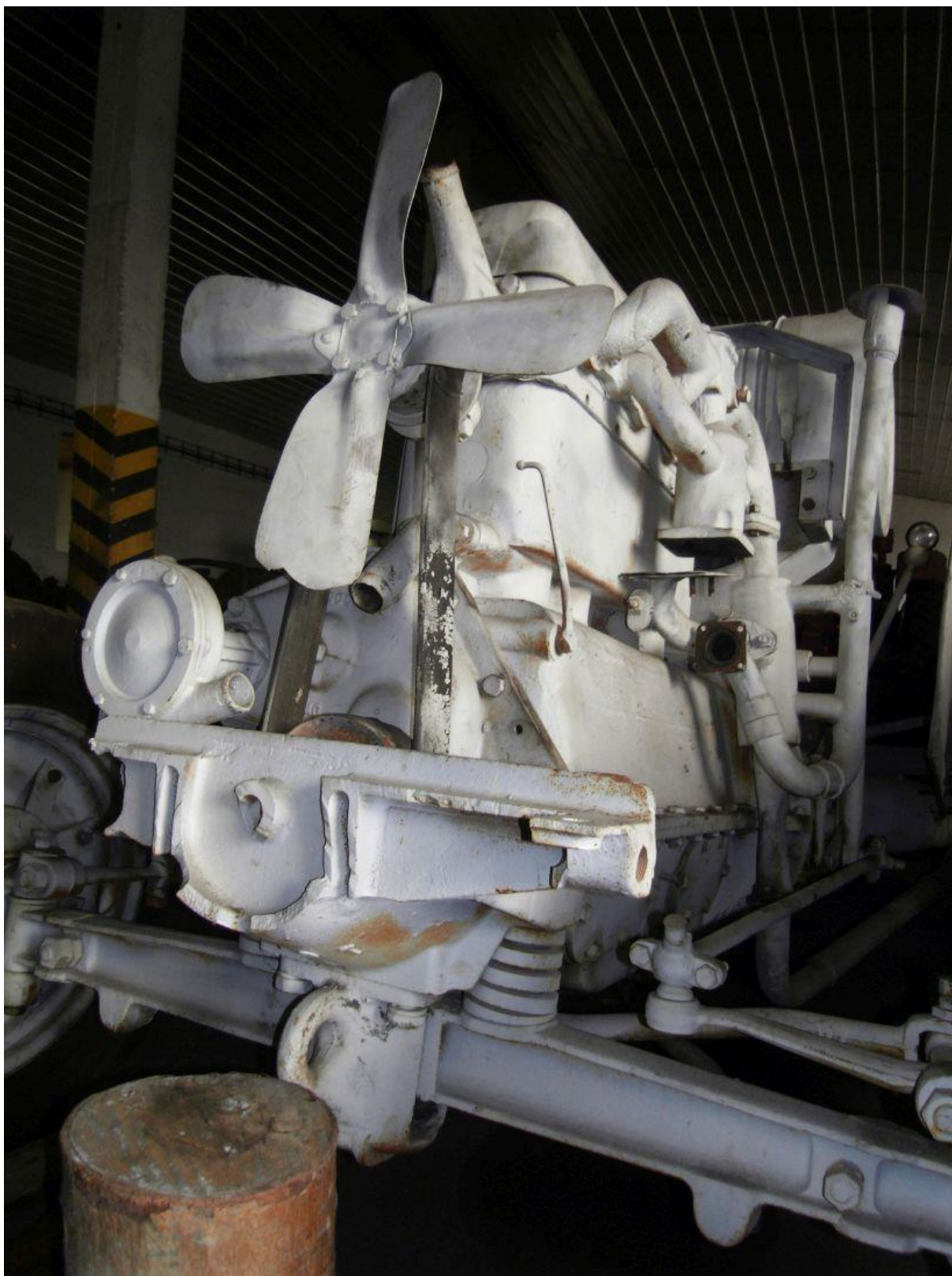
Obr. 5 Traktor Hanomag i detail pšedku stroje se zniž eným nosiřem chladiře.
