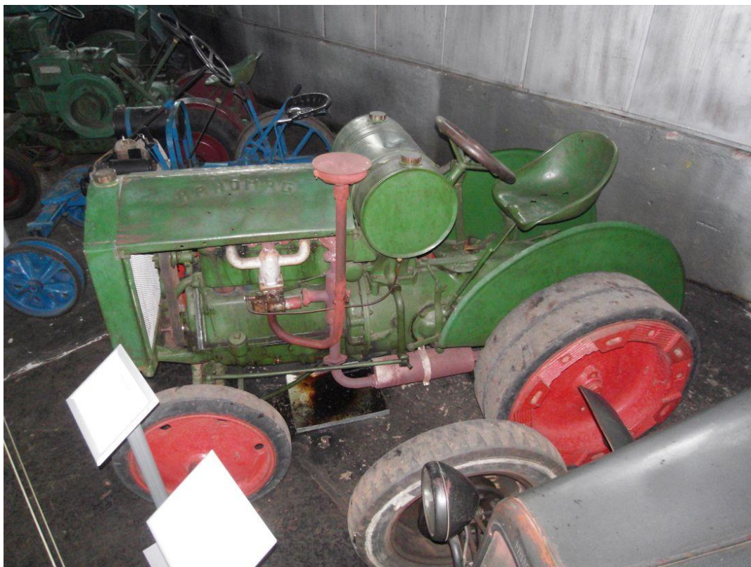
Obr. 6 Druhý Hanomag WD 28/32 umístěný v expozici NZM poslouží jako vzor pro výrobu chybějících dílů (vyjma kol ovšem).
