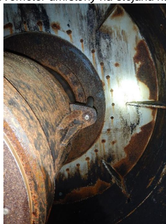
čelo tlumicí komory a kotvení ke kotevnímu kusu
