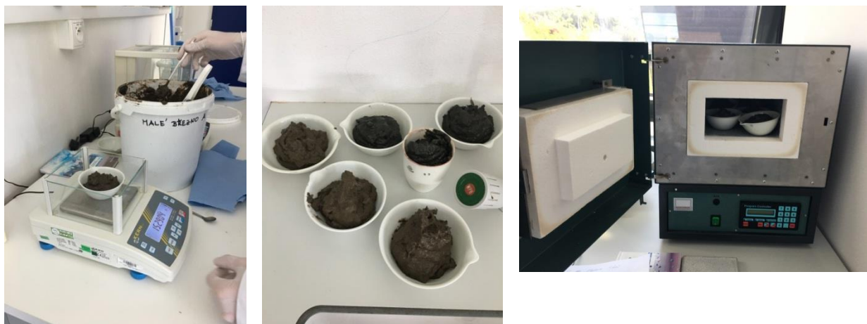
Obrázek 8: Příprava vzorků pro ošetření termickou desorcí
