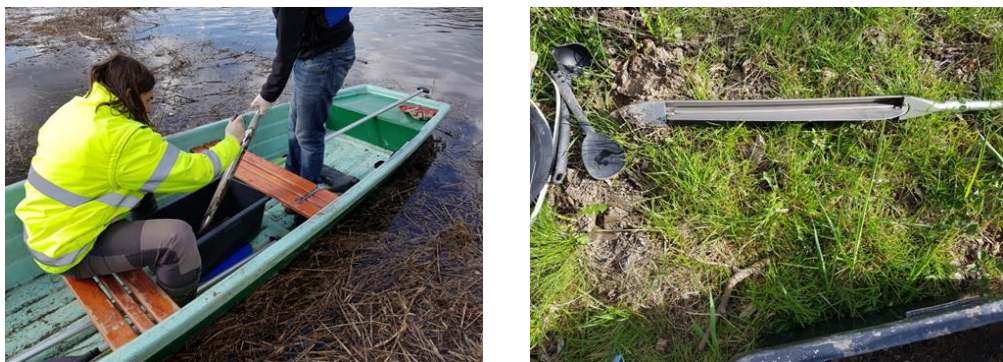
Obrázek 2: Odběry sedimentů pomocí mechanického vzorkovače
