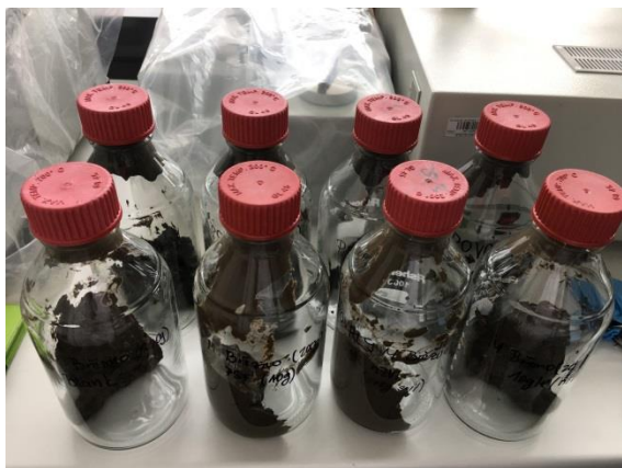
Obrázek 13: Příprava experimentu – navážka zeminy a vody
