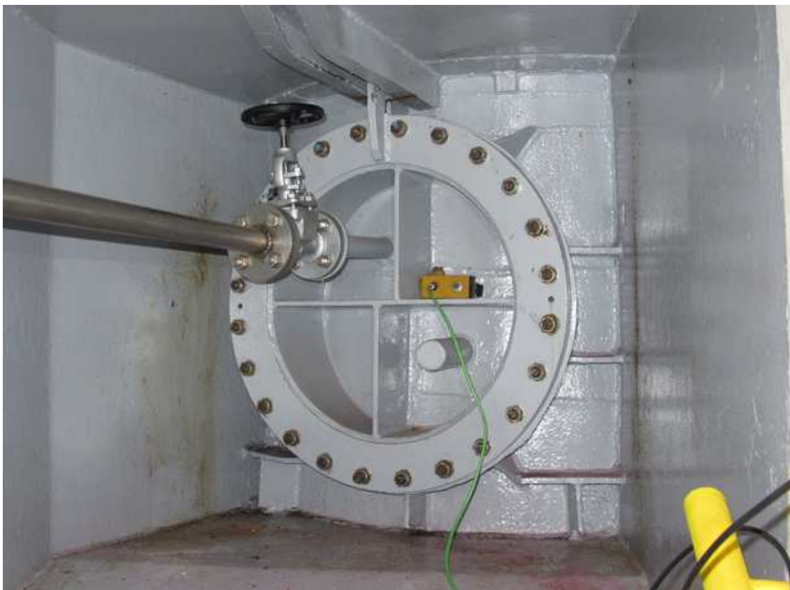
Obr. 5 - Upevnění kontaktního ultrazvukového mikrofону na víku savky
