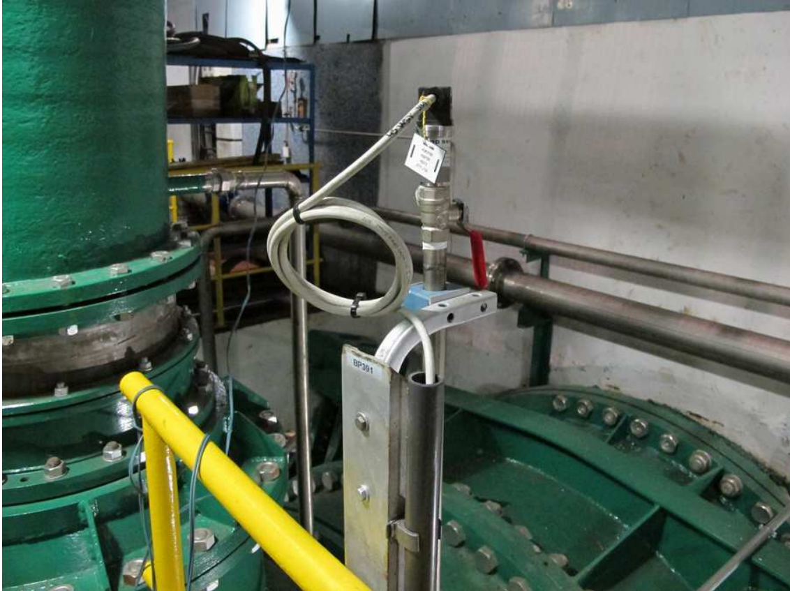
Obr. 3 - Připojení snímače tlaku p_1 do sběrače tlaku
