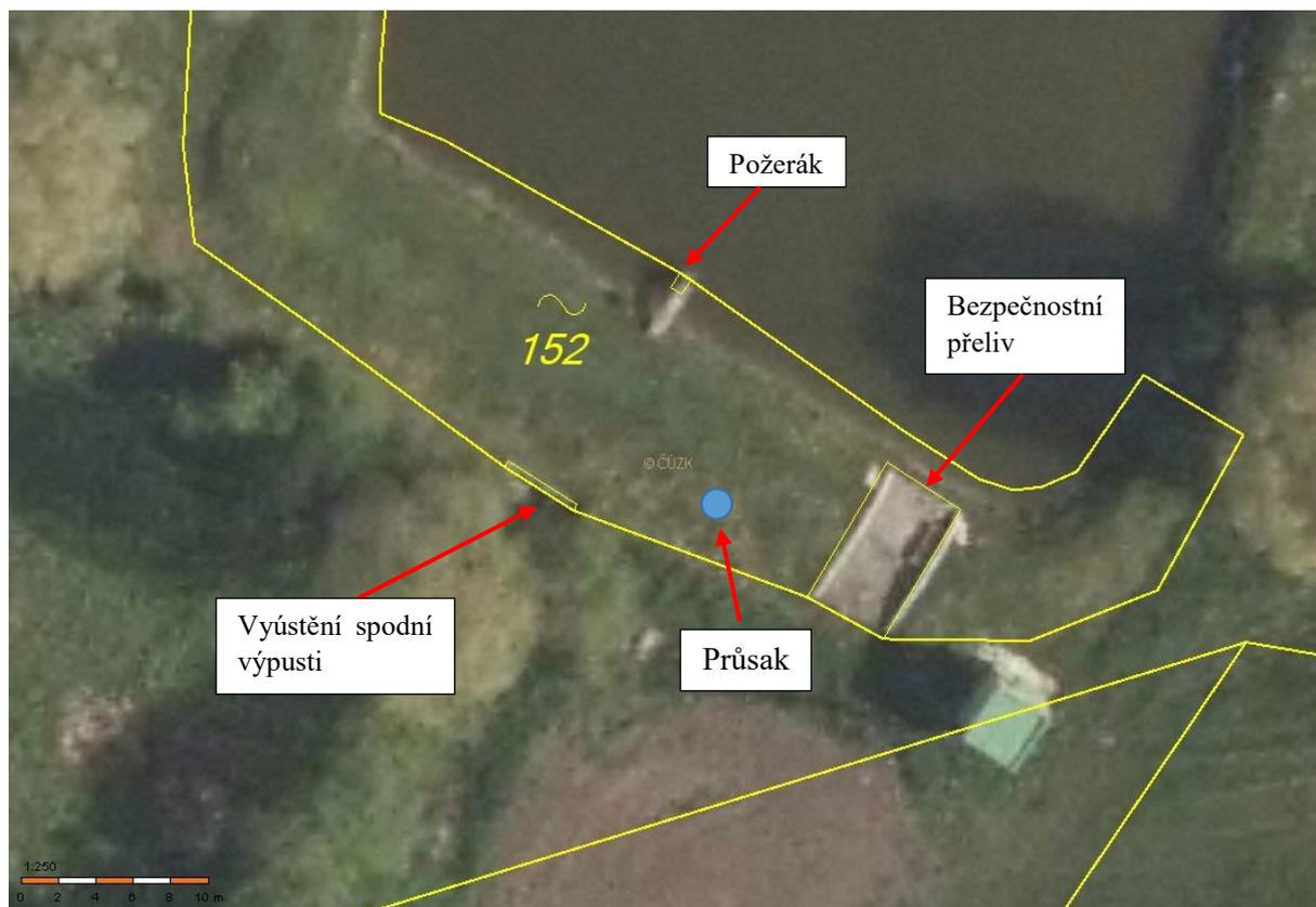
Obrázek 2. Situace hráze s vyznačením místa průsaku na vzdušné straně hráze
