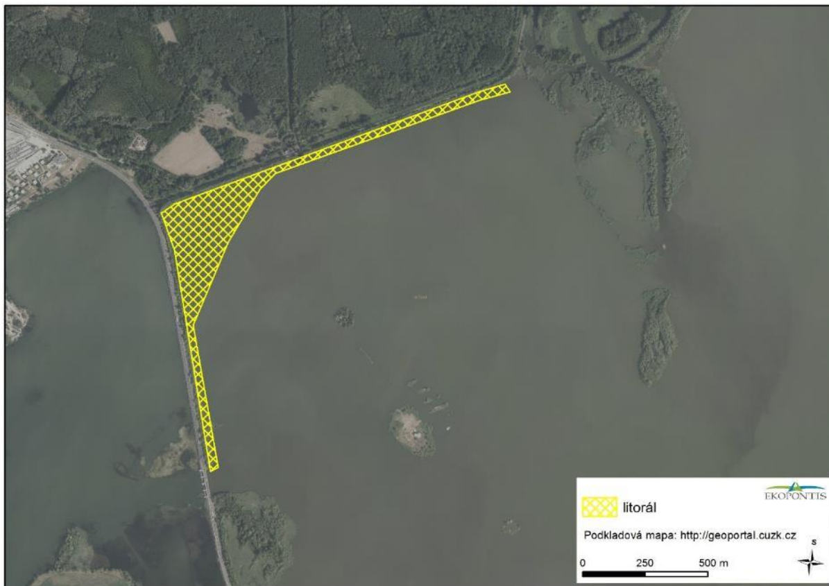
Obrázek 7 Nově vzniklé litorální plochy realizované za pomoci předhrázků
