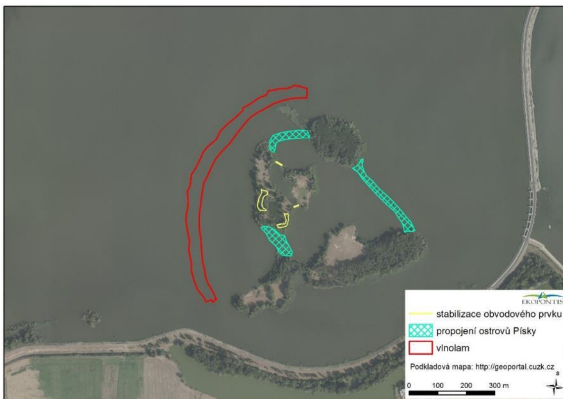
Obrázek 1 Realizace vlnolamu a stabilizace obvodového prvku na kritických místech SZ ostrova (oddělení centrální části laguny na SZ ostrově) v kombinaci s propojením ostrovů za vzniku další laguny oddělené od vlastního prostoru Střední nádrže
