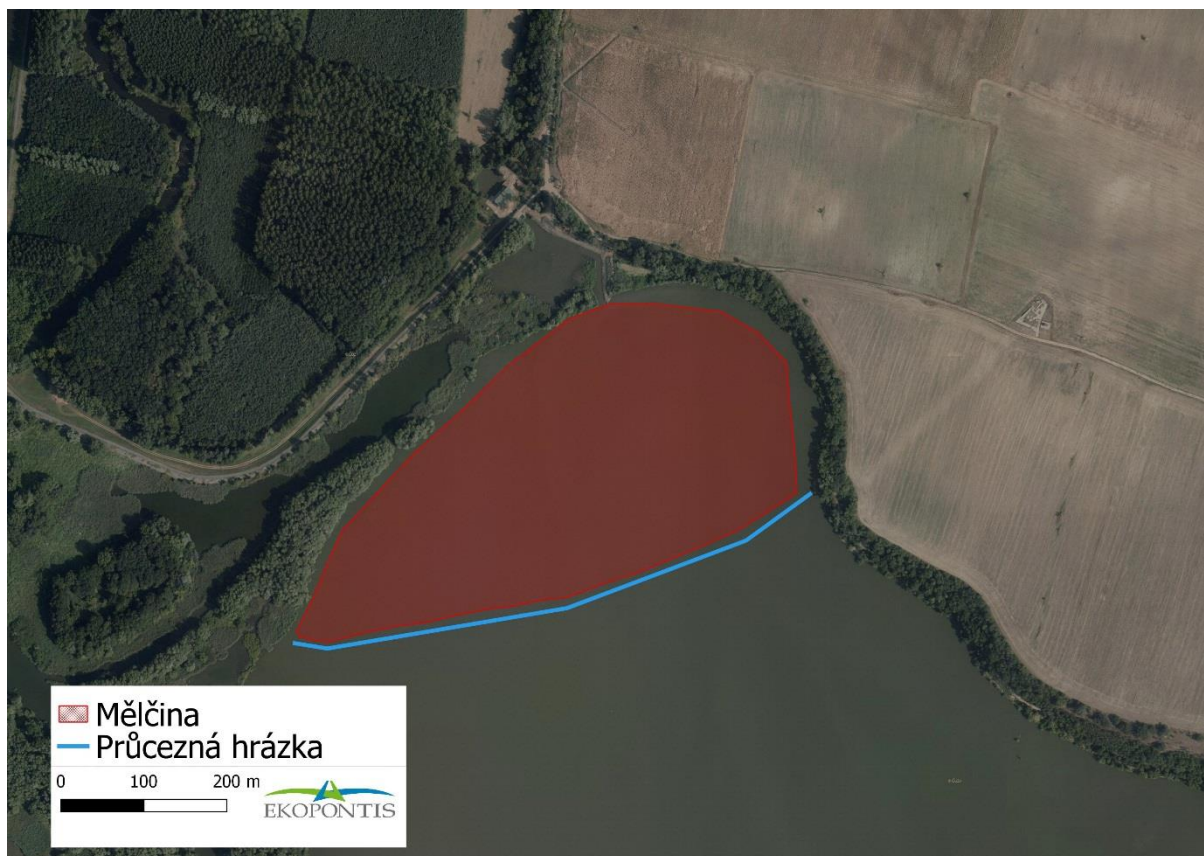
Obrázek 8 Mělčina v Pouzdřanské zátocě oddělená od zbytku nádrže ostrovy (jde pouze o koncepční představu, která bude případně specifikována v dalších stupních přípravy záměru (možné je např. realizace více menších ostrovů apod.), příp. průcezní gabionovou hrázkou
