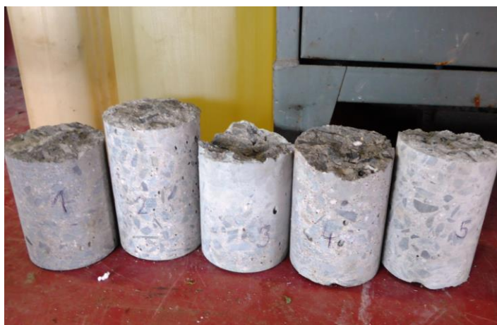
obr. 21 a 22 záznam hodnot odrazu, zkouška Schmidtovým sklerometrem, vzorky jádrových vrtů
