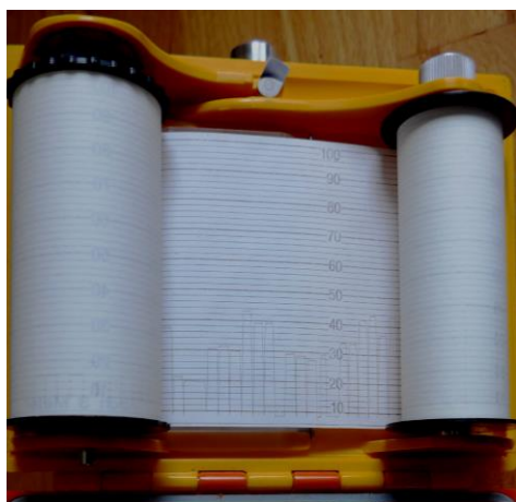
obr. 21 a 22 záznam hodnot odrazu, zkouška Schmidtovým sklerometrem, vzorky jádrových vrtů
