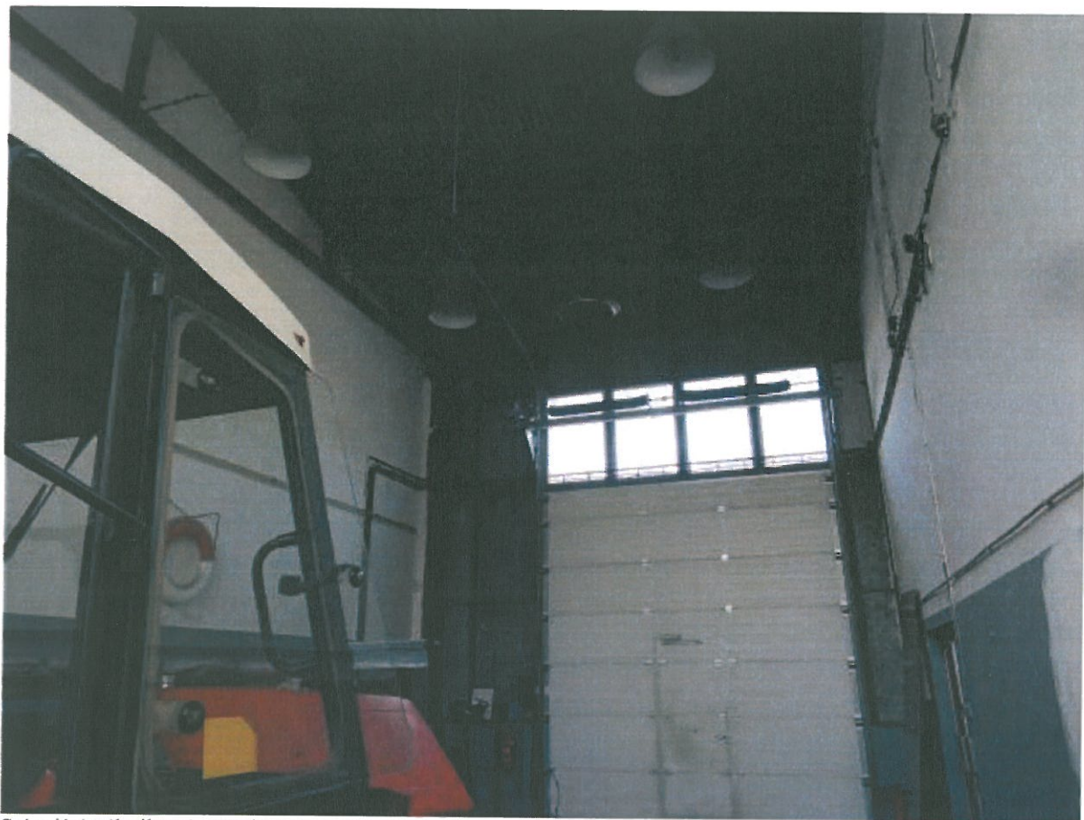
Stávající výbojkové osvětlení v garáži nevyhovující pomalým rozsvěcením a spektrem světla
