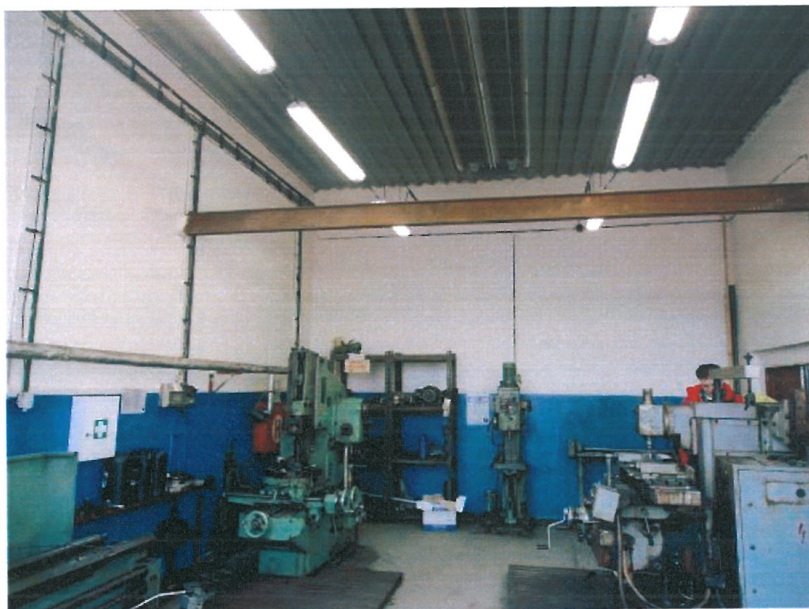
Dílňa kovoobrábění a některé stávající kovoobráběcí stroje, současné zářivkové svítidla se nahradí led svítidla nezpůsobující stroboskopický efekt při práci na točivých strojích z důvodu zvýšení bezpečnosti práce! Stroje se nově připojí k novým podružným rozvaděčům s ochrannými prvky dle platných ČSN.
