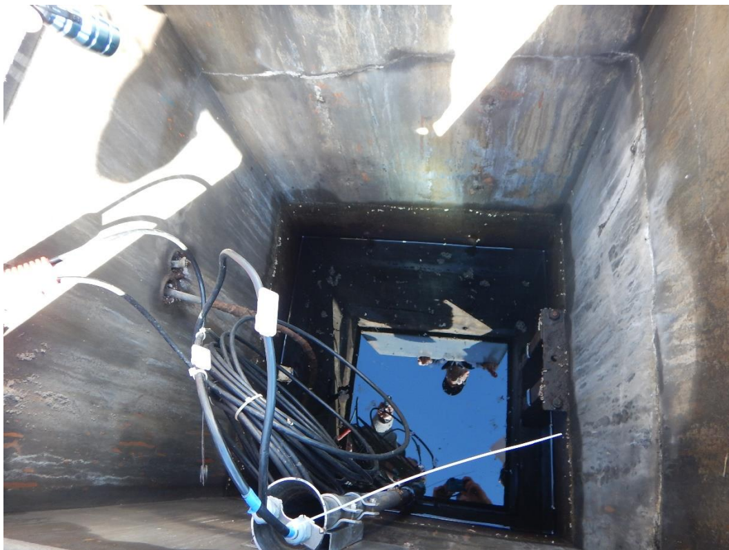
Obr. Pohled do šachty limnigrafu
