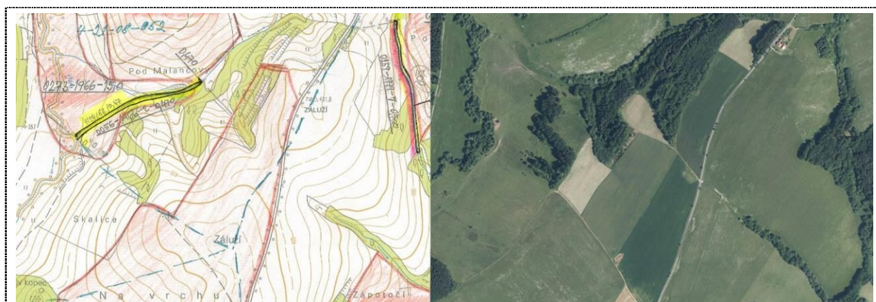
Obr. 6: Plošná odvodnění (červeně označené plochy) a HMZ (žlutě zvýrazněné linie) na původních podkladech (vlevo) a současný stav území (vpravo). Naprostá většina plošných i některá otevřená HMZ nejsou v terénu patrná (s výjimkou výustí). Plošná odvodnění jsou datována 1966, 1977 a 1979, dnes neexistující svodnice z roku 1966 je naposledy patrná na snímcích z roku 2006, svodnice vpravo byla upravena v roce 1979.
