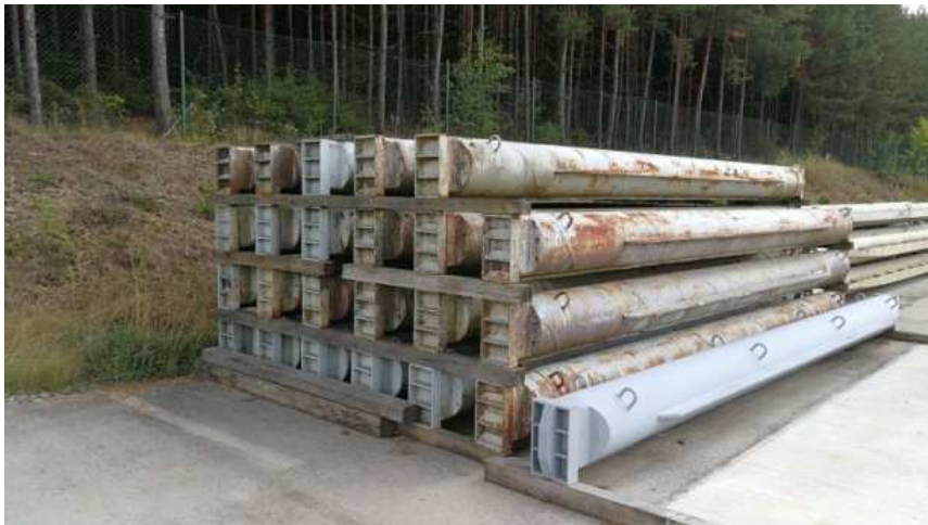
Trubky provizorního hrazení plavební komory
