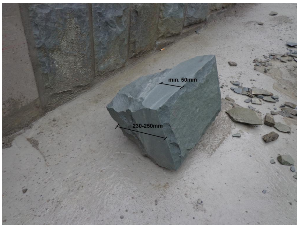
opracovaný kámen pro čisté řádkové zdivo (celková tloušťka kamene 230-250mm, řezaná část min. 50 mm)
