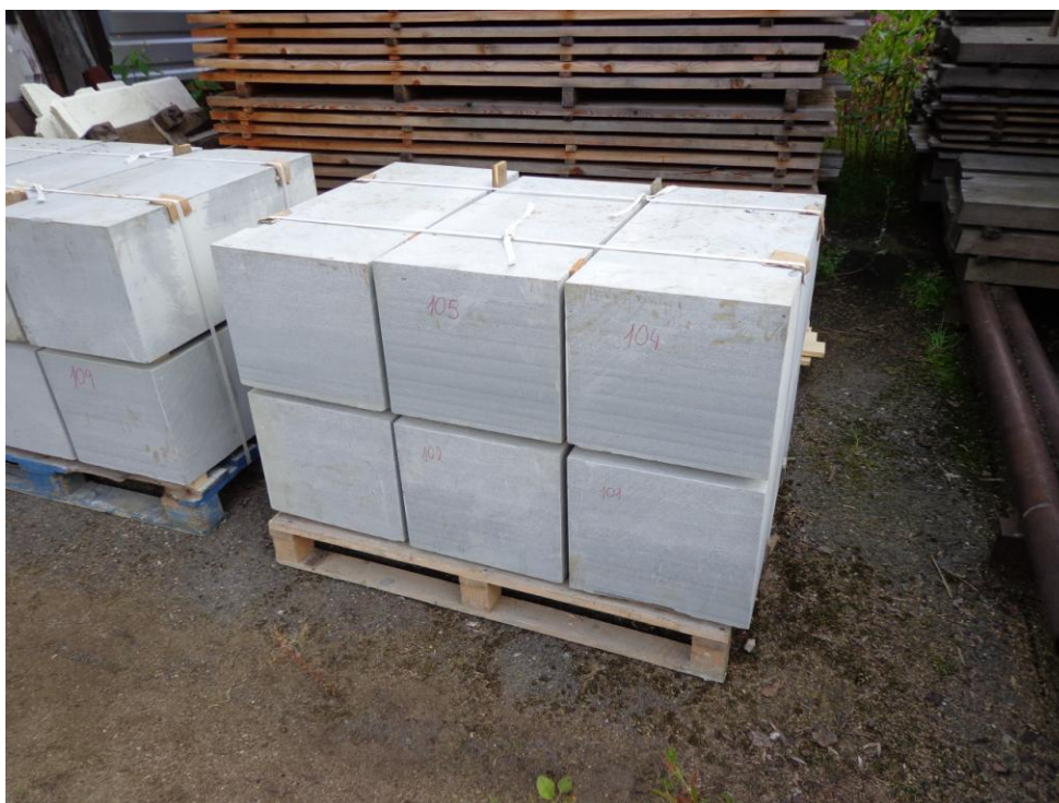
řezaný kámen pro obklad přelivné hrany stupně a závěrného prahu
