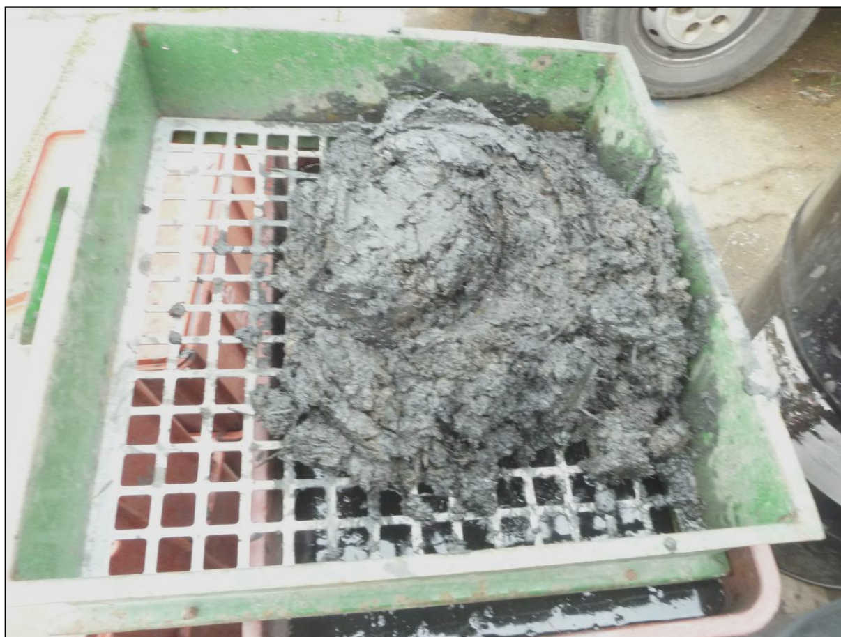
Obr.22: Sítování odebraných vzorků
