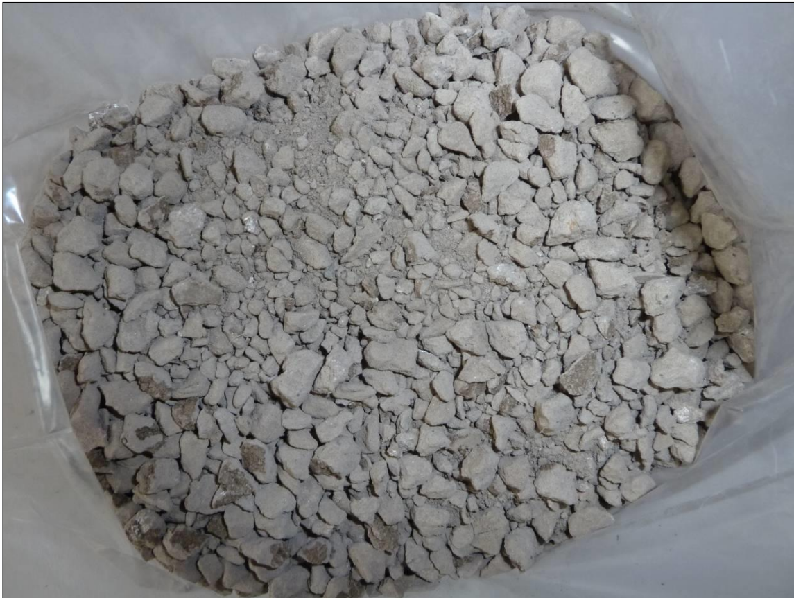
Obr. 21: Mechanicky upravený vzorek pro zkoušky vyluhovatelnosti
