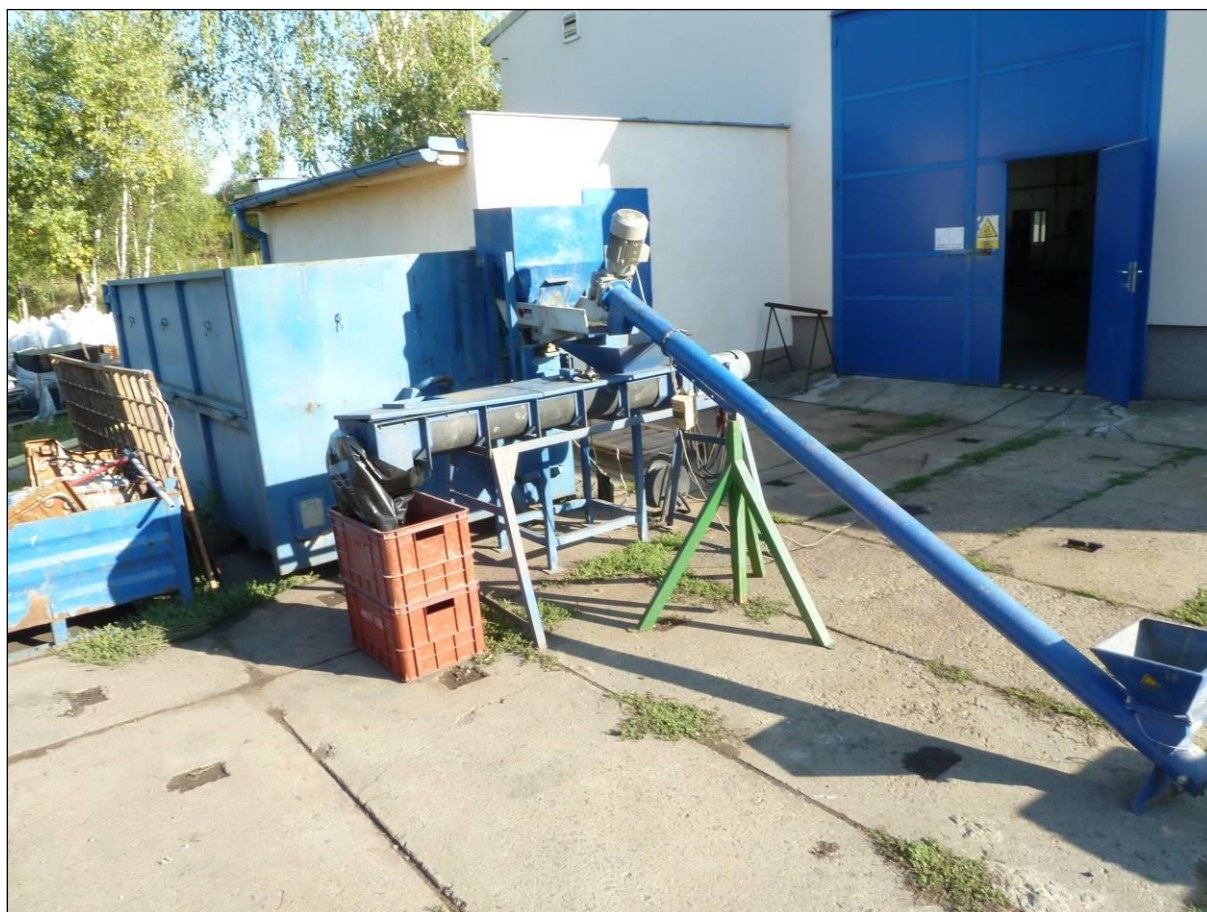
Obr. 29: Zkušební linka stabilizace sedimentů
