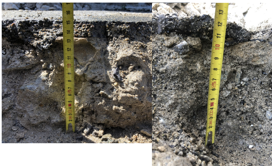
Obrázek 7 – Pohled na konstrukční vrstvy sond
