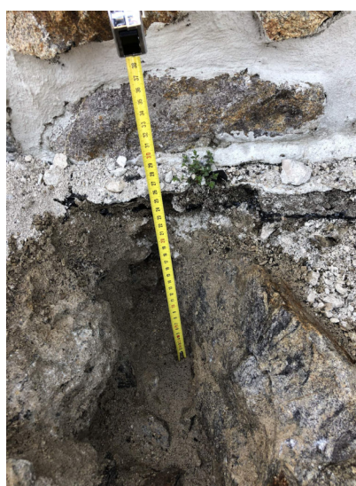
Obrázek 19 – Výška konstrukce vozovky v sondě č. 2
