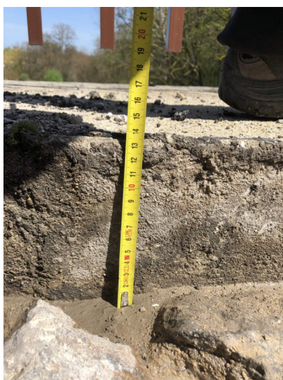
Obrázek 20 – Výška konstrukce vozovky v sondě č. 3
