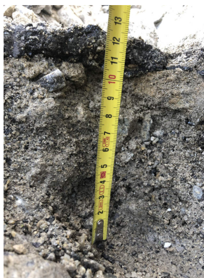
Obrázek 21 – Výška konstrukce vozovky v sondě č. 4
