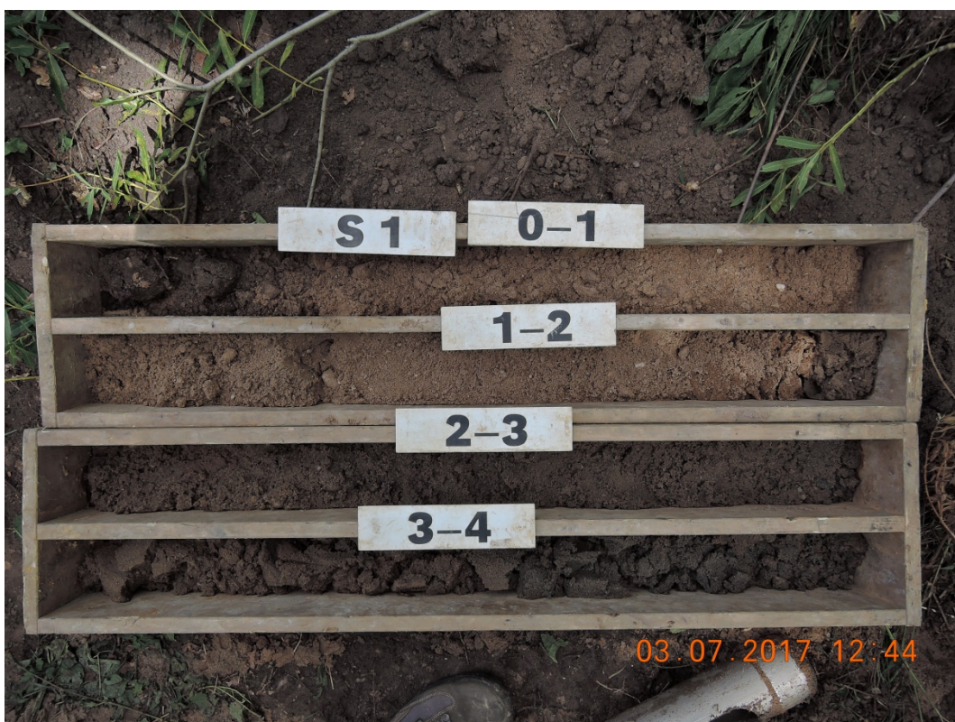
Obr. 4: Geologický profil sondy S1.
