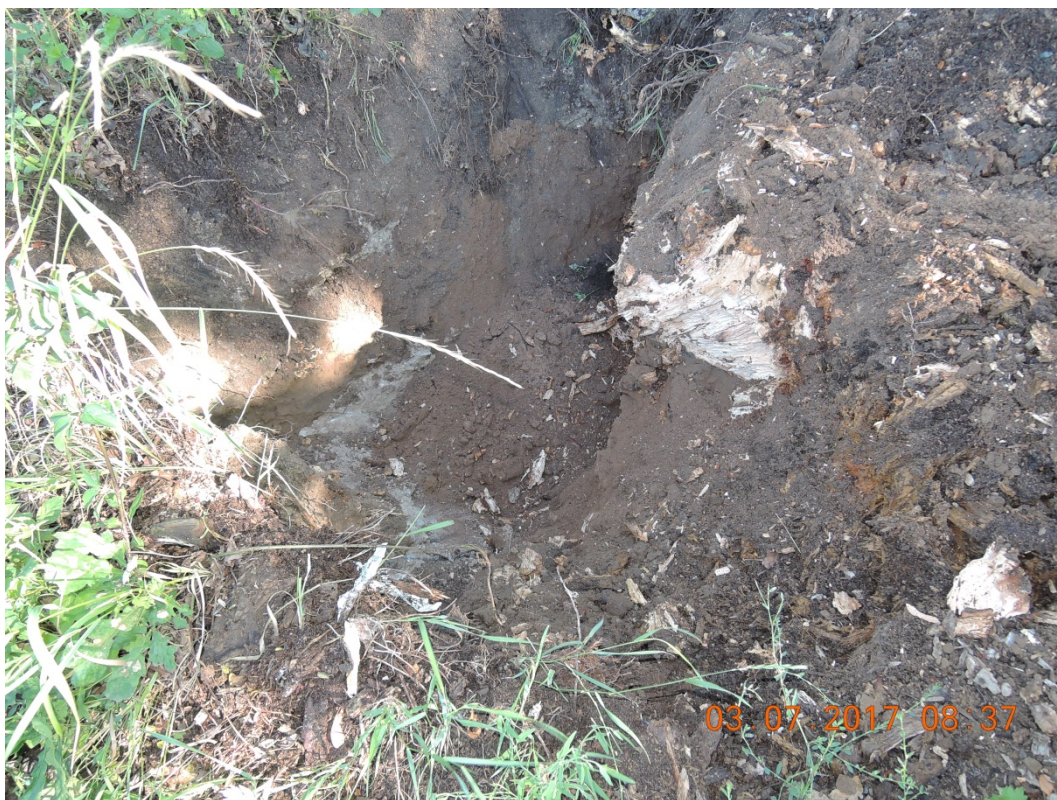
Obr. 2: Svrchní část geologického profilu kopané sondy K1 s nálitky betonu.
