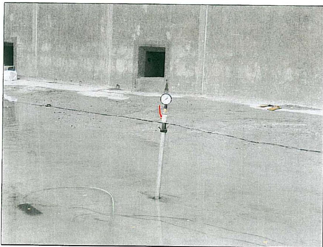
Obr. č. 9: Obturátor s manometrem
