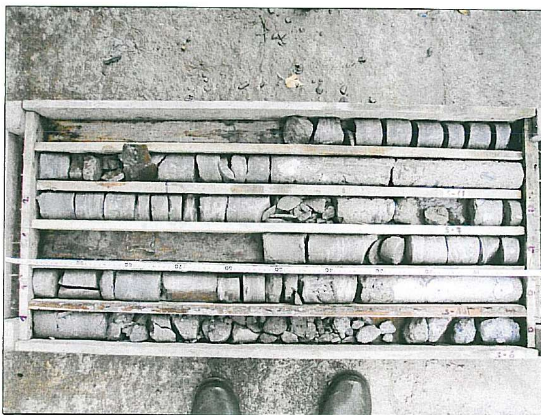
Obr. č. 8: Vrtné jádro vrtů S-11, S-7, S-10 a S-6
