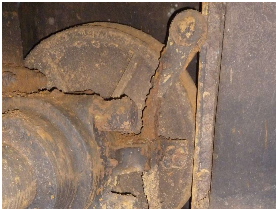
Pohled na pojezdové kolo stavítka po vodě – detail ložiskového domku pojezdového kola, vpravo zpružina s rolnou a opěrná kolejnice
