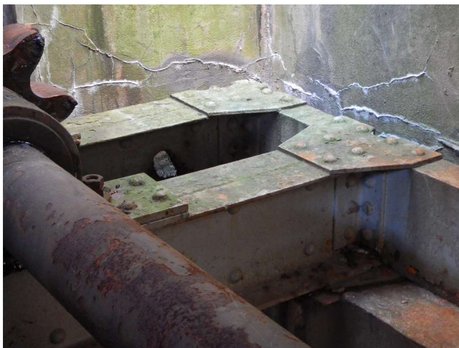
Rám pohybovacího mechanismu – vlevo cévové kolo
