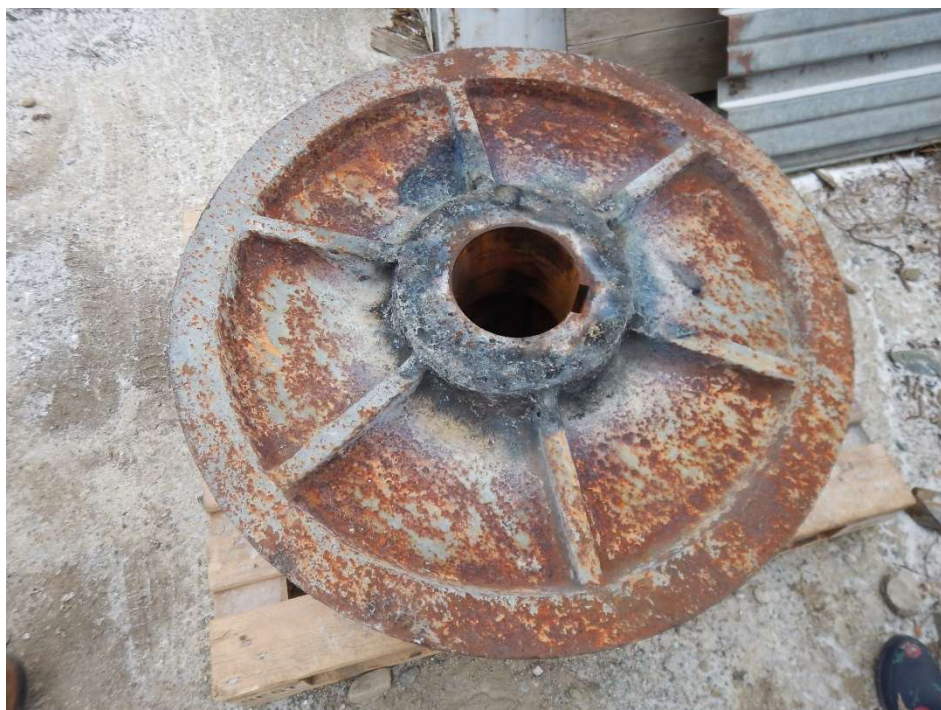
Detail pojezdového kola
