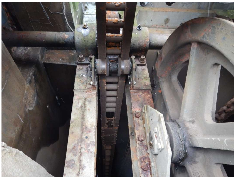
Rám pohybovacího mechanismu – dole přírubové spojení cévové tyče
