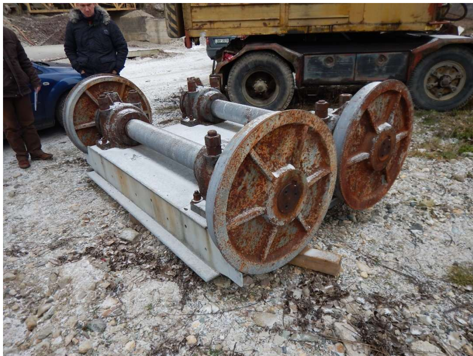
Pohled na stavítko z dolní strany – chybí prahové těsnění, pružiny a jedno pojezdové kolo
