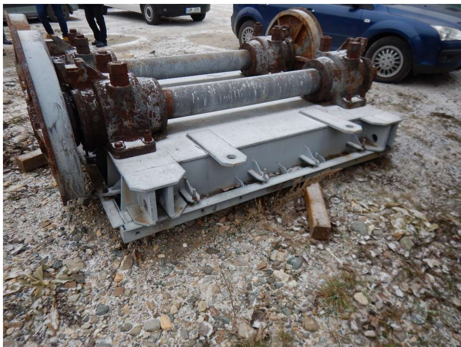
Pohled na stavítko z horní strany – detail závěsů pro cévové tyče a řetězů protizávaží
