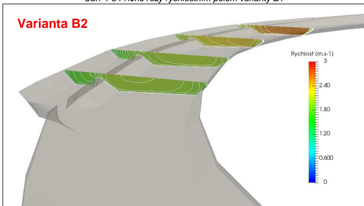
Obr. 4-7 Příčné řezy rychlostním polem varianty B2
