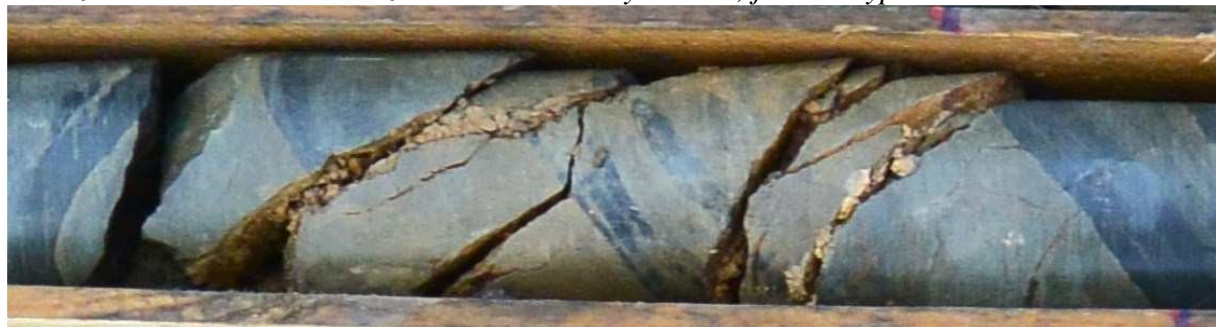
Obrázek č. 8.4: Zelenohnědé zabarvení navětralých drob, jílovitá výplň trhlín
